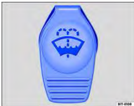
Fig. 73 No compartimento do motor: tampa do reservatório de água dos lavadores do para-brisa.
