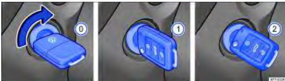
Fig. 97 Ao lado do volante, à direita: posições da chave do veículo no cilindro da ignição.
