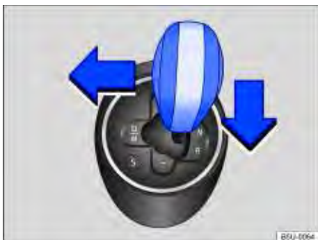
Fig. 104 Alavanca seletora da transmissão automatizada ASG.
