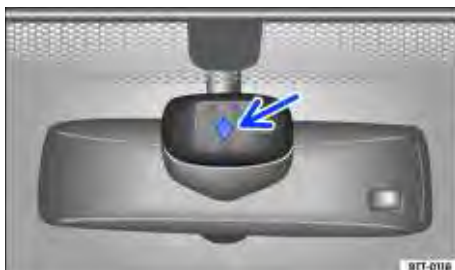
Fig. 72 No para-brisa: superfície sensível do sensor de chuva.
