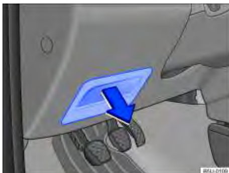
Fig. 164 No lado do condutor no painel de instrumentos: cobertura da caixa de fusíveis.
