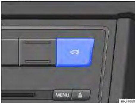
Fig. 32 Na parte superior do console central: tecla de abertura da tampa do compartimento de bagagem.
