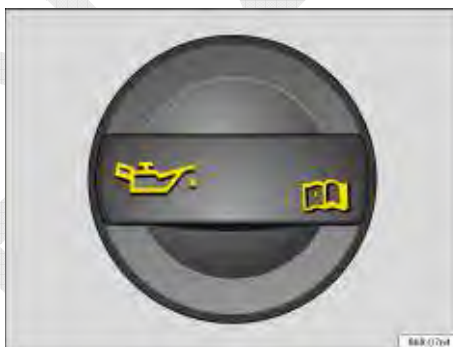
Fig. 127 No compartimento do motor: tampa da abertura de enchimento de óleo do motor.
