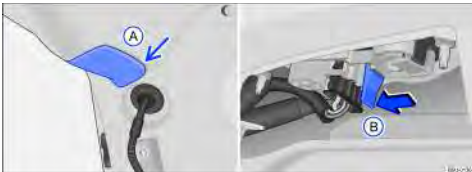
Fig. 183 Na tampa do compartimento de bagagem: remover a cobertura e suporte das lâmpadas.
