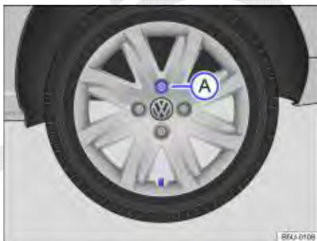
Fig. 159 Retirar a supercalota.
