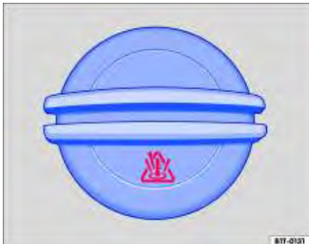
Fig. 130 No compartimento do motor: tampa do reservatório do líquido de arrefecimento do motor.
