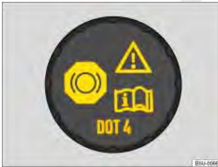
Fig. 110 No compartimento do motor: tampa do reservatório de fluido do freio.
