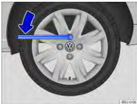
Fig. 161 Troca de roda: afrouxar os parafusos da roda.
