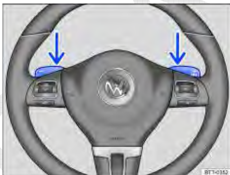
Fig. 106 Volante com dois seletores basculantes para troca de marcha no modo manual.
