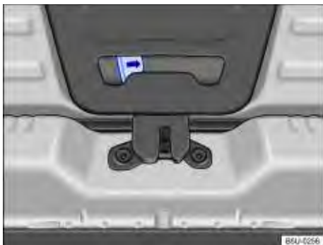
Fig. 155 Do lado de dentro do compartimento de bagagem: destravamento de emergência da tampa do compartimento de bagagem.
