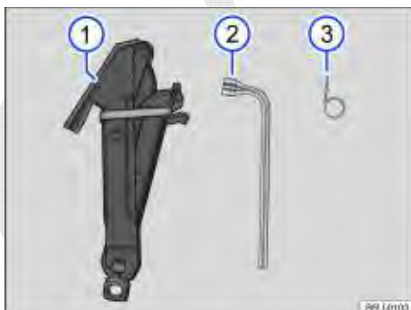
Fig. 158 Componentes das ferramentas de bordo.
