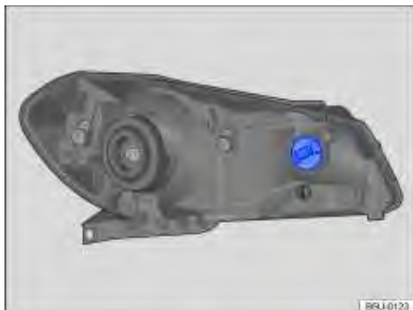
Fig. 174 No compartimento do motor: localização da lâmpada incandescente do indicador de direção dianteiro.
