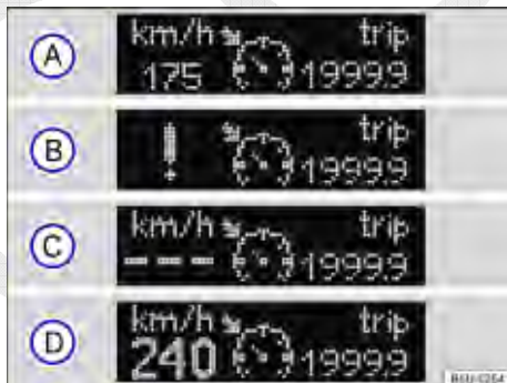
Fig. 116 No display do instrumento combinado: indicadores de status do GRA.
