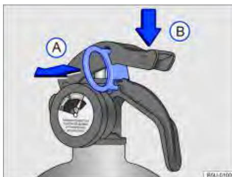
Fig. 150 Sequência de utilização do extintor de incêndio.
