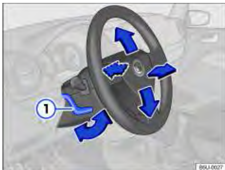
Fig. 44 Ajustar a posição do volante mecanicamente.
