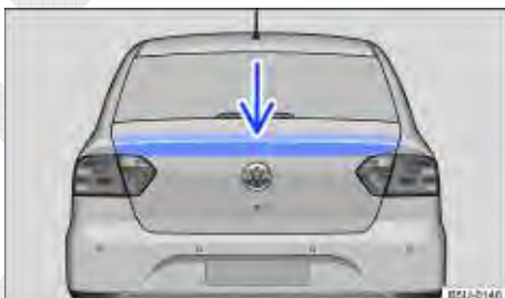
Fig. 34 Tampa do compartimento de bagagem fechada: região para fechamento.
