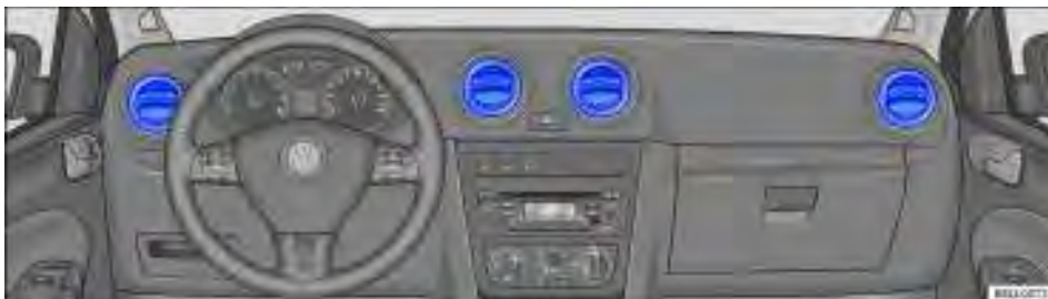
Fig. 120 Difusores de ar no painel de instrumentos.
