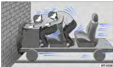
Fig. 47 Um veículo com os ocupantes do veículo sem cintos de segurança colide com o muro.
