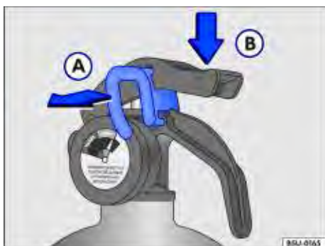
Fig. 149 Sequência de utilização do extintor de incêndio.
