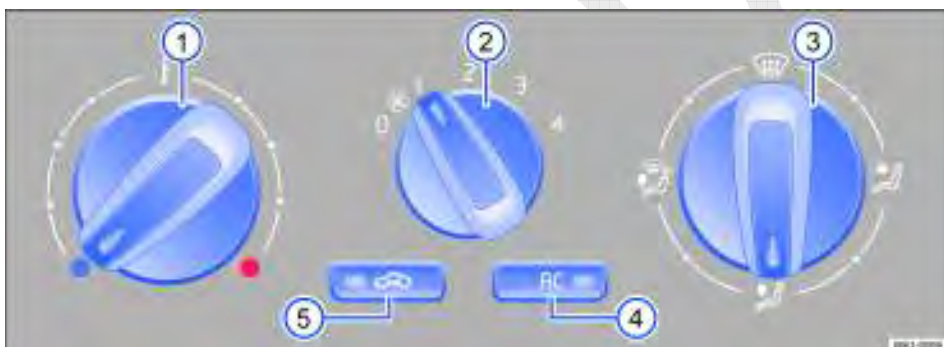
Fig. 119 No console central: comandos do ar-condicionado.
