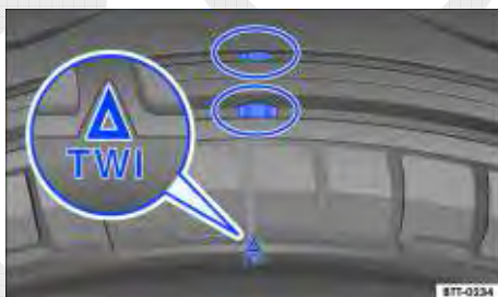
Fig. 139 Perfil do pneu: indicador de desgaste.
