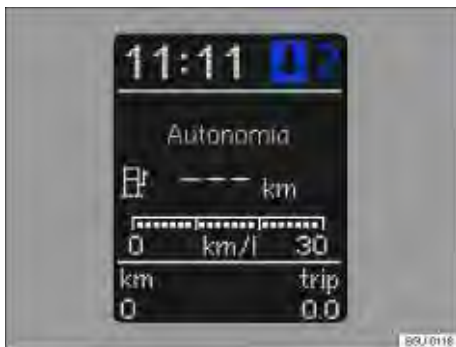
Fig. 102 No instrumento combinado: indicador de troca de marcha.
