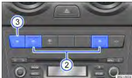
Fig. 36 No console central: teclas dos vidros elétricos traseiros.
