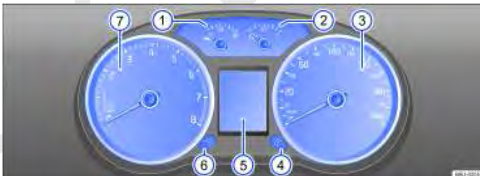
Fig. 10 Instrumento combinado no painel de instrumentos.
