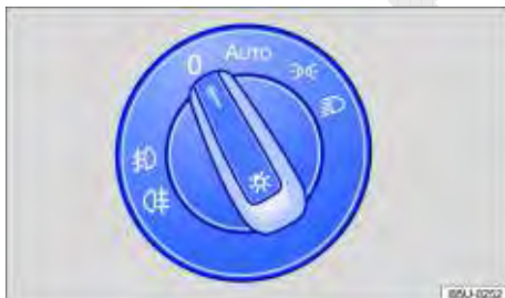
Fig. 66 No painel: interruptor giratório das luzes.
