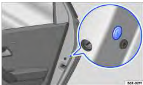
Fig. 153 Na parte dianteira da porta traseira direita: travamento de emergência, coberto por uma vedação de borracha.
