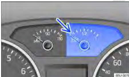
Fig. 122 No instrumento combinado: indicador da reserva de combustível.
