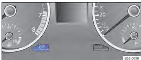
Fig. 61 No instrumento combinado: tecla de regulagem da iluminação dos instrumentos e dos interruptores.
