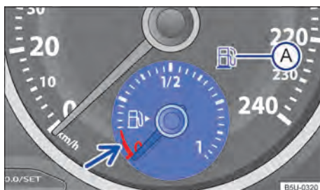
Fig. 120 No instrumento combinado: indicador do nível de combustível (variante 2).
