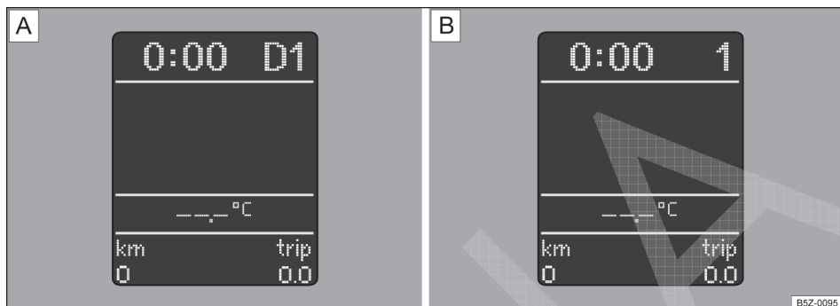
Fig. 99 A Posições da alavanca seletora no display: indicação da alavanca no modo de condução automatizada (Modo normal), com a 1ª marcha engatada. B Posições da alavanca seletora no display: modo de condução manual, com a 1ª marcha selecionada.
