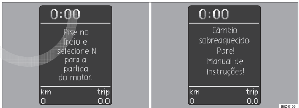
Fig. 103 Display do instrumento combinado: textos de advertência. ▶
