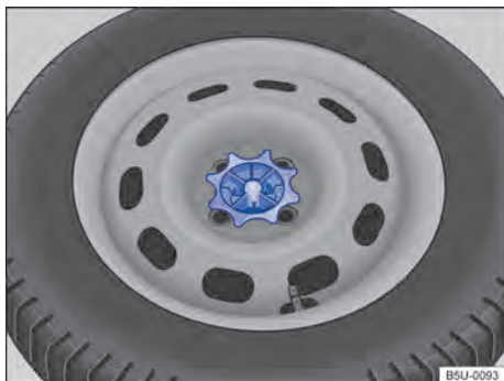
Fig. 136 No compartimento de bagagem: manipulador para fixação da roda de emergência.
