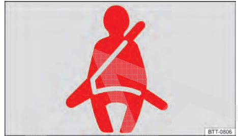
Fig. 42 Luz de advertência no display do instrumento combinado.
