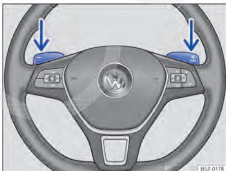
Fig. 102 Volante com dois seletores para troca de marcha no modo manual.
