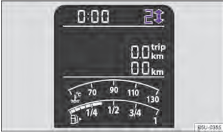
Fig. 97 No instrumento combinado: indicador de troca de marcha (variante 1).
