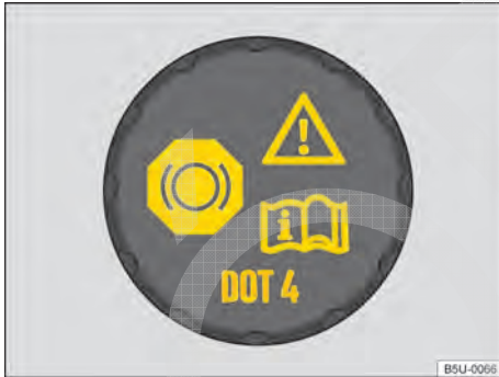
Fig. 106 No compartimento do motor: tampa do reservatório de fluido de freio.
