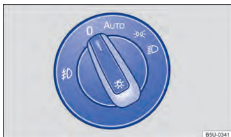
Fig. 60 No painel: interruptor das luzes.
