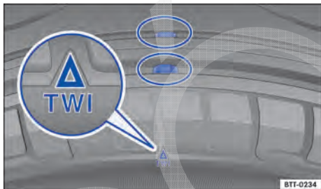
Fig. 135 Perfil do pneu: indicadores de desgaste.
