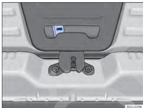
Fig. 158 Do lado de dentro do compartimento de bagagem: destravamento de emergência da tampa do compartimento de bagagem.
