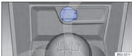
Fig. 91 No console central dianteiro: tomada 12 V.
