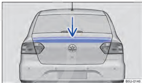
Fig. 30 Tampa do compartimento de bagagem fechada: região para fechamento.
