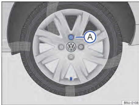
Fig. 142 Troca de roda: seqüência de remoção dos parafusos da roda.
