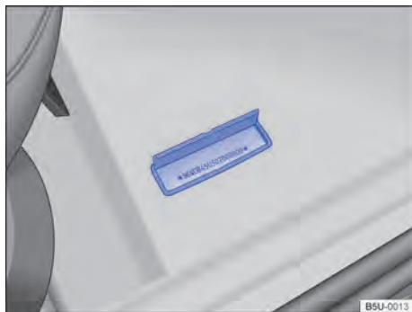
Fig. 178 Em frente ao banco do passageiro dianteiro: número de identificação do veículo (número do chassi) no assoalho, em frente ao banco do passageiro dianteiro.
