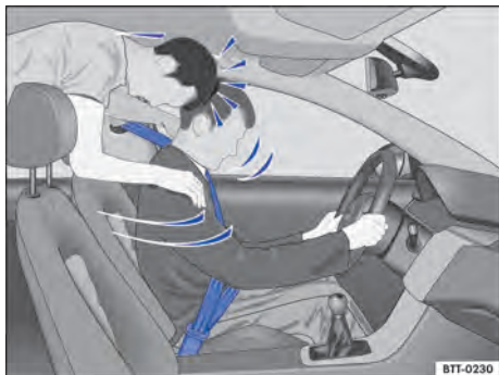
Fig. 46 O passageiro sem cinto de segurança no banco traseiro é lançado para frente sobre o condutor com cinto de segurança.
