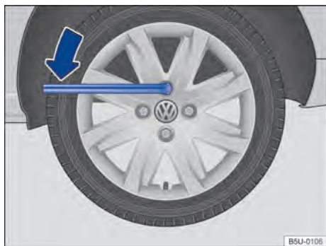
Fig. 140 Troca de roda: soltar os parafusos da roda.
