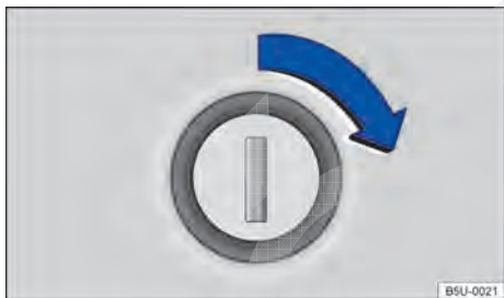
Fig. 27 Abrir a tampa do compartimento de bagagem por fora.
