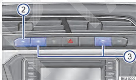
Fig. 32 No console central: teclas dos vidros elétricos traseiros.
