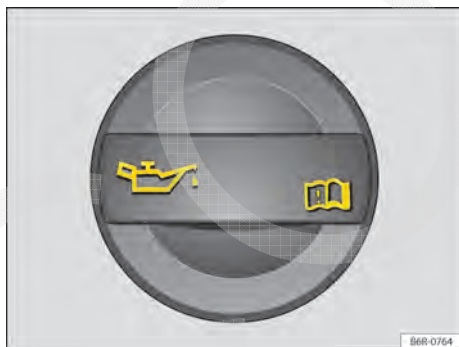
Fig. 125 No compartimento do motor: tampa da abertura para enchimento de óleo do motor.
