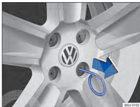
Fig. 138 Retirar as capas de cobertura dos parafusos da roda.
