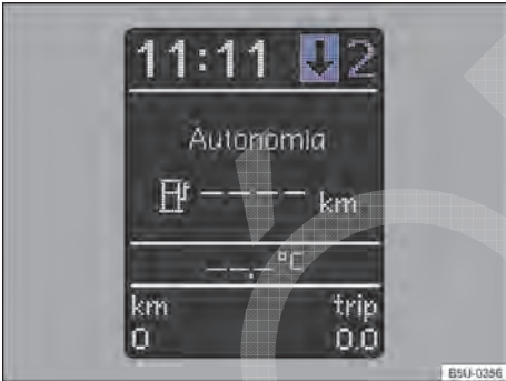
Fig. 98 No instrumento combinado: indicador de troca de marcha (variante 2).
