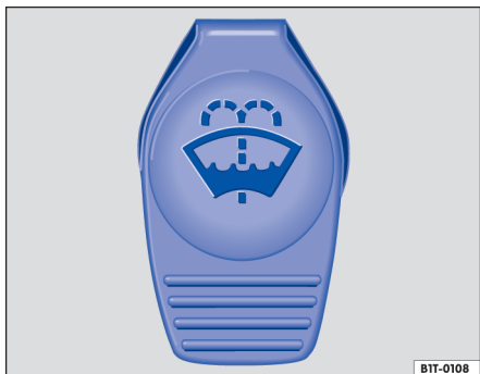
Fig. 129 No compartimento do motor: tampa do reservatório de água dos lavadores do para-brisa.
