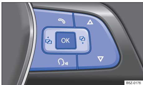
Fig. 20 Lado direito do volante multifunções: teclas de comando dos menus do instrumento combinado.
