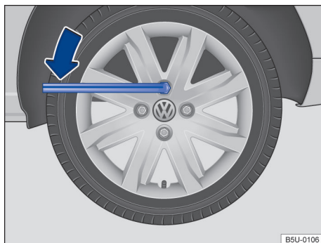
Fig. 145 Troca de roda: soltar os parafusos da roda.
