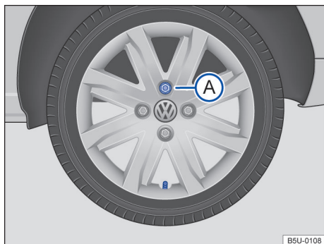
Fig. 147 Troca de roda: sequência de remoção dos parafusos da roda.
