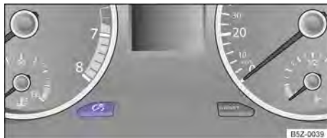
Fig. 66 No instrumento combinado: tecla de regulagem da iluminação dos instrumentos e dos interruptores.
