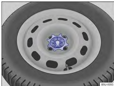
Fig. 208 No compartimento de bagagem: manípulo para fixação da roda de emergência.
