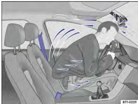
Fig. 25 O condutor sem cinto de segurança é lançado para frente.
