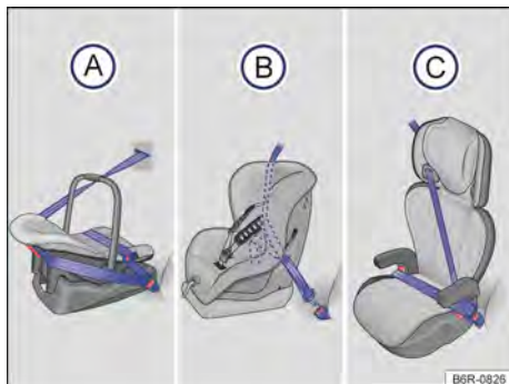
Fig. 35 As ilustrações (A), (B) e (C) mostram a fixação do sistema de retenção para crianças apenas com o cinto de segurança do veículo.
