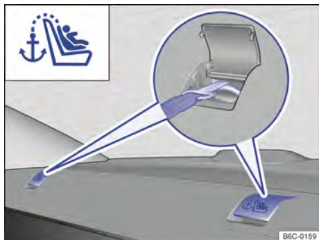
Fig. 38 Olhal de retenção para o cinto de fixação superior na cobertura do compartimento de bagagem.
