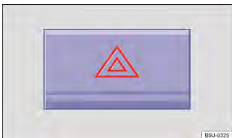
Fig. 41 Na parte superior do console central: interruptor das luzes de advertência.
