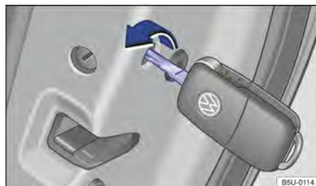
Fig. 50 Travamento de emergência do veículo com a chave do veículo.
