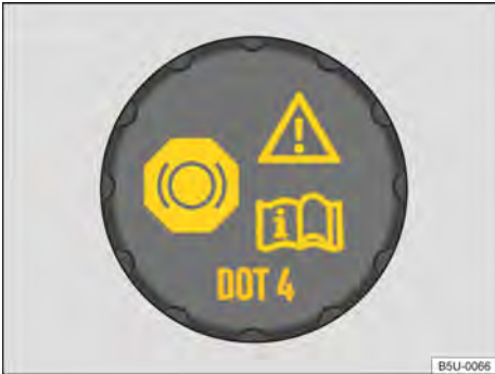
Fig. 201 No compartimento do motor: tampa do reservatório de fluido de freio.
