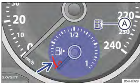
Fig. 14 No instrumento combinado: indicador do nível de combustível (variante 2).
