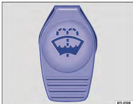
Fig. 196 No compartimento do motor: tampa do reservatório de água dos lavadores do para-brisa.
