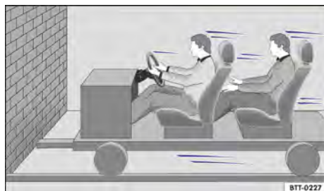
Fig. 23 Um veículo com os ocupantes do veículo sem cintos de segurança está em rota de colisão com um muro.
