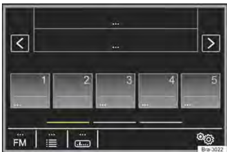
Fig. 142 Operação do rádio: busca automática em andamento (SCAN).
