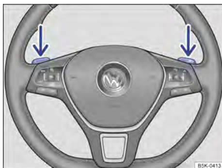
Fig. 86 Volante com seletores basculantes do Tiptronic.
