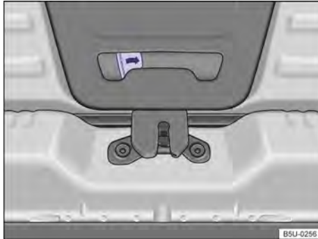
Fig. 53 Do lado de dentro do compartimento de bagagem: destravamento de emergência da tampa traseira.
