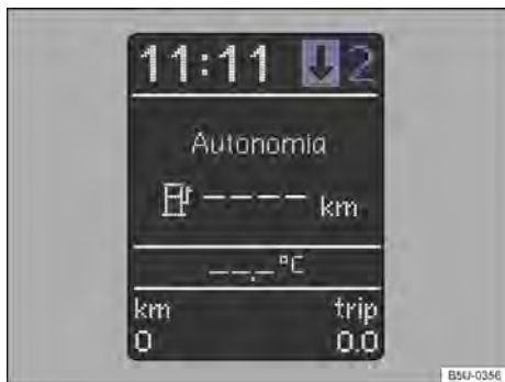
Fig. 79 No instrumento combinado: indicador de troca de marcha (variante 2).
