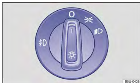
Fig. 64 Ao lado do volante: interruptor de luzes.
