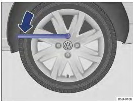
Fig. 212 Troca de roda: soltar os parafusos da roda.
