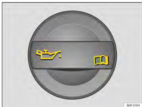
Fig. 198 No compartimento do motor: tampa da abertura para enchimento de óleo do motor.
