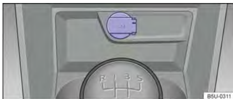
Fig. 100 No console central dianteiro: tomada 12 V.
