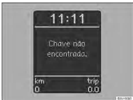
Fig. 82 No instrumento combinado: display com indicação do imobilizador ativado - veículos com Sistema de Informações Volkswagen.
