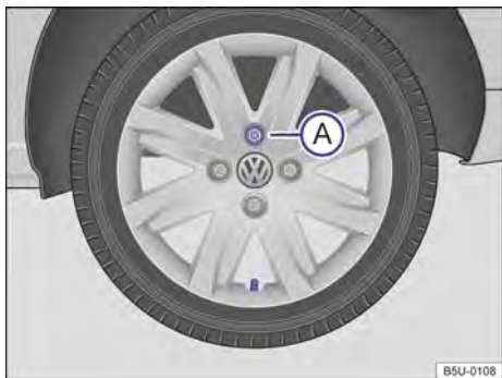
Fig. 214 Troca de roda: seqüência de remoção dos parafusos da roda.
