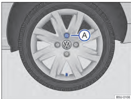
Fig. 189 Retirar a supercalota.
