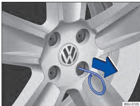
Fig. 188 Retirar as capas de cobertura dos parafusos da roda.
