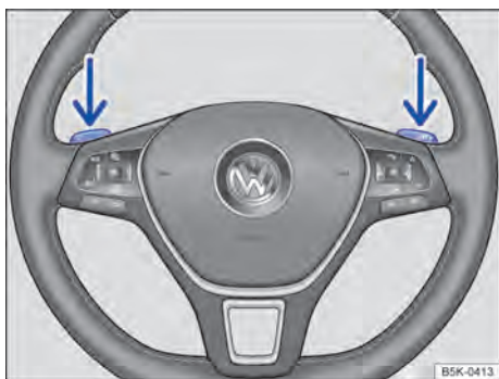
Fig. 85 Volante com seletores basculantes do Tiptronic.
