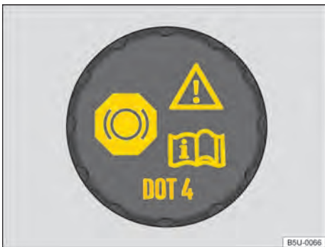
Fig. 179 No compartimento do motor: tampa do reservatório de fluido de freio.
