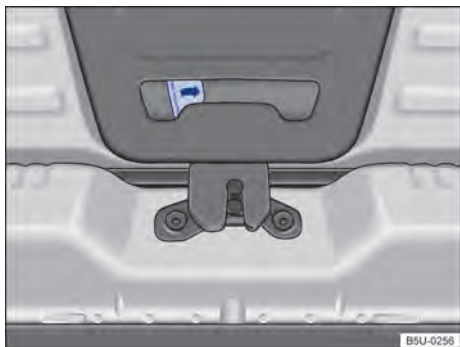
Fig. 52 Do lado de dentro do compartimento de bagagem: destravamento de emergência da tampa traseira.
