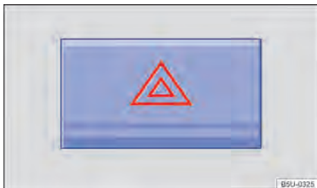
Fig. 40 Na parte superior do console central: interruptor das luzes de advertência.
