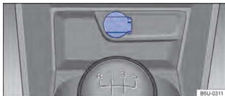
Fig. 99 No console central dianteiro: tomada 12 V.
