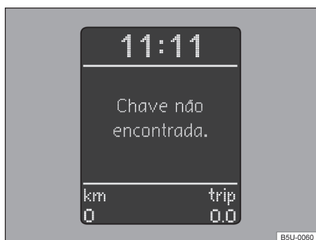
Fig. 81 No instrumento combinado: display com indicação do imobilizador ativado - veículos com Sistema de Informações Volkswagen.
