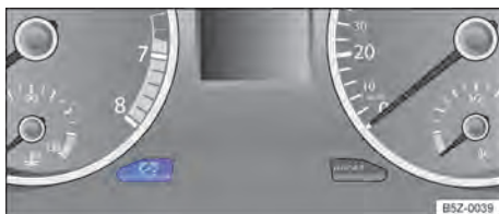
Fig. 65 No instrumento combinado: tecla de regulagem da iluminação dos instrumentos e dos interruptores.
