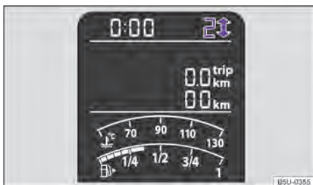
Fig. 77 No instrumento combinado: indicador de troca de marcha (variante 1).
