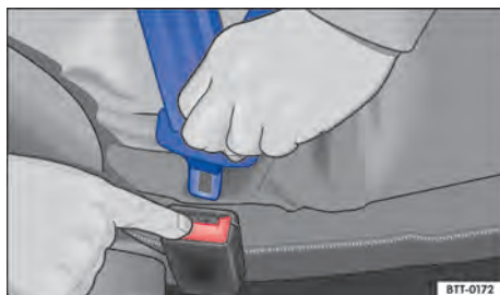
Fig. 28 Soltar a lingueta do cinto de segurança do fecho do cinto de segurança.
