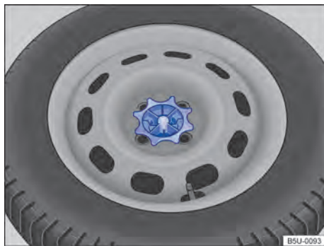
Fig. 186 No compartimento de bagagem: manípulo para fixação da roda de emergência.
