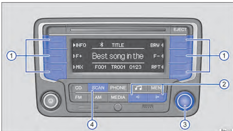
Fig. 141 Exemplo de exibição na operação de mídia: selecionar os modos de reprodução.
