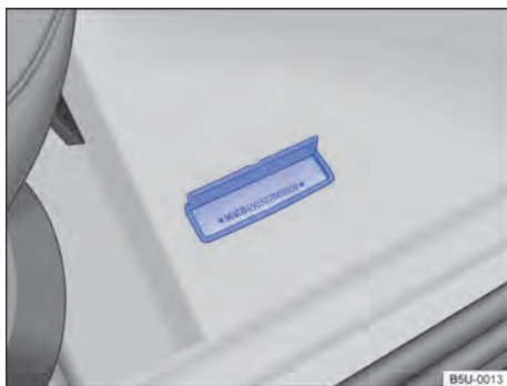
Fig. 196 Em frente ao banco do passageiro dianteiro: número de identificação do veículo (número do chassi) no assoalho, em frente ao banco do passageiro dianteiro.
