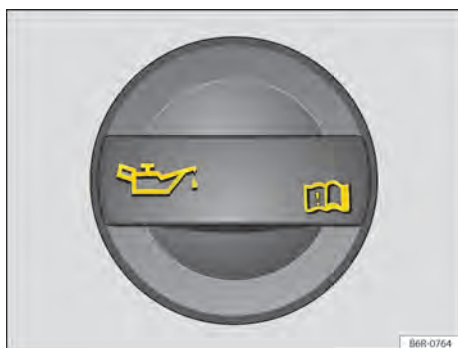
Fig. 176 No compartimento do motor: tampa da abertura para enchimento de óleo do motor.
