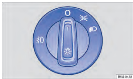
Fig. 63 Ao lado do volante: interruptor de luzes.
