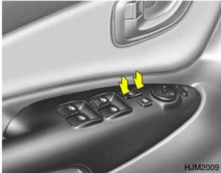
O interruptor de fecho centralizado das portas está situado no apoio para o cotovelo do condutor. O fecho centralizado é accionado quando é premido o interruptor do fecho das portas.
