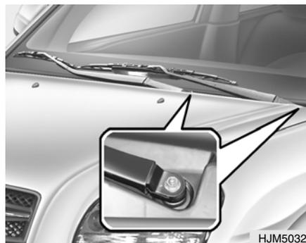
As escovas do limpa-parabrisas devem ser inspeccionadas de tempo a tempo e limpas para retirar a película de pó e sujidade acumuladas. Para limpá-las, deverá usar uma esponja com água limpa e sabão.
