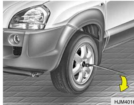
Baixar o veículo até ao solo rodando a chave para a esquerda. Posicione a chave como mostra na figura e aperte as porcas das rodas. Verifique se a chave está perfeitamente inserida na porca, para evitar que resvale. Não force a chave com o pé, nem use um tubo como extensão da chave. Aperte todas as porcas das rodas. Recomenda-se um segundo aperto a todas as porcas. Depois de uma mudança de roda, é aconselhável a revisão e o aperto por um técnico, logo que possível.
