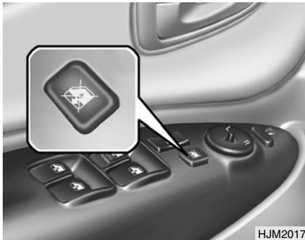
Para evitar a operação das janelas dos passageiros da frente e de trás, foi instalado um interruptor de travamento das janelas no apoio para o cotovelo existente na porta do condutor. Para desactivar o mecanismo dos vidros, prima o interruptor de travamento das janelas. Para activar de novo o modo de operação normal, prima novamente o interruptor de travamento das janelas.
