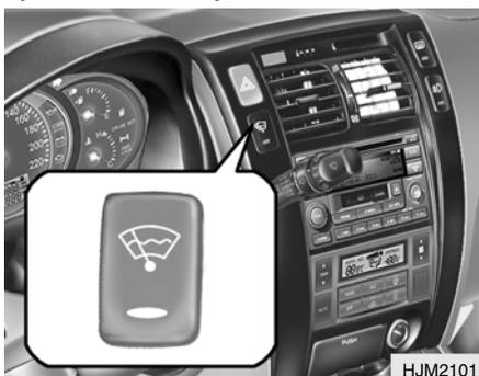
O sistema de desembaçamento do vidro da frente pode ser activado premindo o interruptor adequado. Para desligar o desembaçamento prima novamente o interruptor. O sistema de desembaçamento do vidro dianteiro desliga-se automaticamente depois de decorridos 20 minutos.
