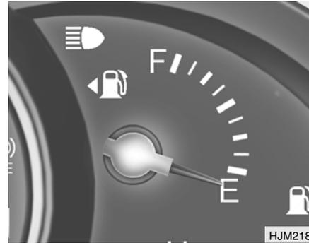
A agulha do manómetro, indica o nível de combustível no depósito, seja qual for a posição da chave.
