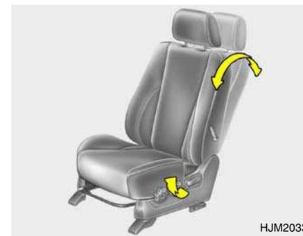
Para soltar as costas do banco, incline-se para a frente para lhe retirar peso, então puxe para cima a alavanca de controlo de inclinação, situada lateralmente no banco do lado da porta, incline-se para trás até ter o ângulo de inclinação desejado. Para fixar as costas do banco na posição desejada, solte a alavanca de controlo de inclinação.
