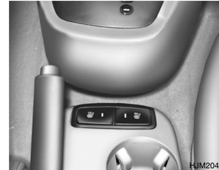
O aquecimento do banco é fornecido para aquecer o banco da frente durante o tempo frio. com a chave da ignição na posição "ON", carregue nos interruptores na consola da frente para aquecer o banco do condutor ou o banco do passageiro.
