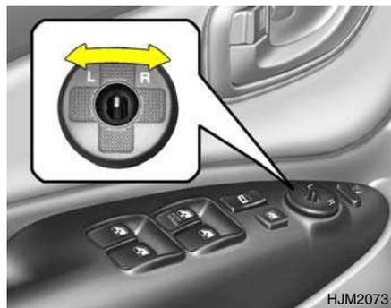
O retrovisor exterior pode ser orientado em qualquer direcção, de forma a obter o máximo de visão para trás. O interruptor dos retrovisores com comando eléctrico actua sobre os retrovisores de ambos os lados do carro.
