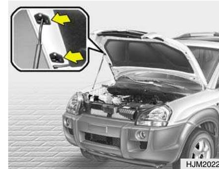
2. Empurre para a esquerda a alavanca do trinco de segurança e levante o capot.
