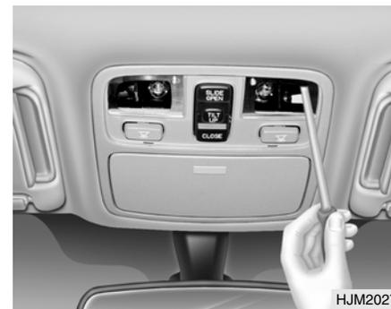
2. Utilize uma chave de caixa para rodar os parafusos no sentido contrário aos ponteiros do relógio para remover a consola de tecto.
