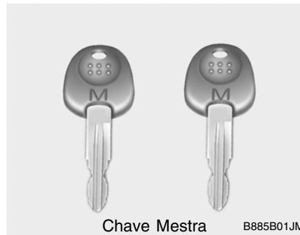
Todas as fechaduras que equipam o veículo são accionadas pela mesma chave. No entanto, e uma vez que é possível trancar as portas sem utilizar a chave, deverá ser tomada precaução a fim de evitar que as chaves fiquem inadvertidamente no interior do veículo após trancar as portas.
