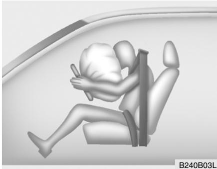
Após o accionamento, os recortes moldados directamente nas coberturas dos air bag separam-se devido à pressão de expansão dos air bag. Estas coberturas abrem-se totalmente, permitindo assim o enchimento total dos air bag.
