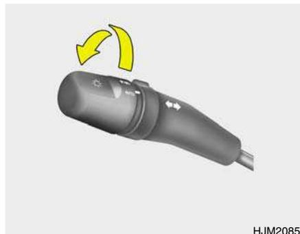
Para activar as luzes automáticas, rodar o comando do interruptor multifunções até ao fim. Se colocar o interruptor multifunções na posição "AUTO", as luzes exteriores (luzes de presença e faróis) acendem-se e apagam-se automaticamente em função da iluminação exterior.
