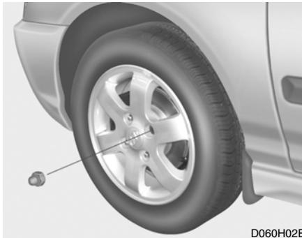
Coloque as porcas nos pernes e ajuste-as com os dedos. As porcas deverão ser colocadas com o seu diâmetro inferior virado para dentro. Oscile a roda para se assegurar que está perfeitamente encaixada e volte a ajustar as porcas com os seus dedos.
