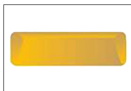
Segregadores - segregam pista para uso exclusivo de determinado tipo de veículo ou pedestre
