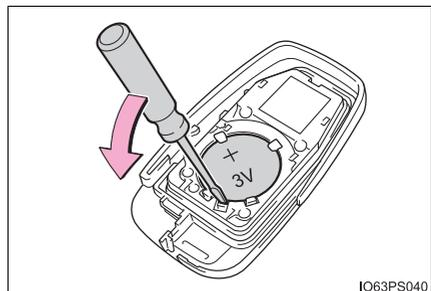
Ao remover a bateria, utilize uma chave de fenda de tamanho adequado. Introduza uma bateria nova mantendo o terminal “+” voltado para cima.
