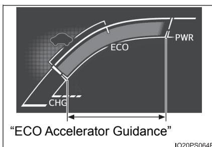
A tela "ECO Accelerator Guidance" (Orientação de Aceleração ECO) muda de acordo com a condição de condução, por exemplo, durante a partida ou durante o controle de velocidade.
