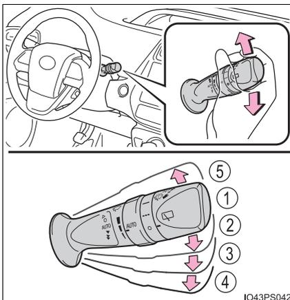
Ao seleccionar “AUTO”, os limpadores funcionarão automaticamente quando os sensores detectarem a precipitação de chuva. O sistema irá ajustar automaticamente o período de intermitência dos limpadores de acordo com o volume da chuva e a velocidade do veículo.
