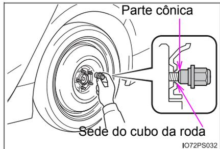
Ao substituir a roda de liga leve por outra equivalente, aperte as porcas até que a parte cônica fique presa entre em contato com o cubo da roda.
