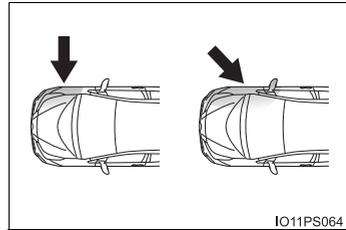
Os sistemas de airbag laterais, em geral, não deflagram se o veículo for envolvido em uma colisão traseira, se capotar, ou ainda em caso de colisão frontal ou lateral em baixa velocidade.
