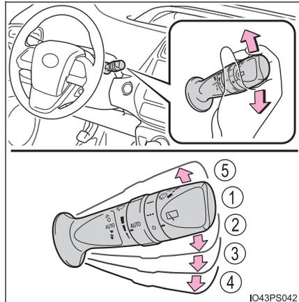
Ao selecionar "AUTO", os limpadores funcionarão automaticamente quando os sensores detectarem a precipitação de chuva. O sistema irá ajustar automaticamente o período de intermitência dos limpadores de acordo com o volume da chuva e a velocidade do veículo.
