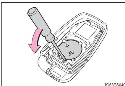
Ao remover a bateria, utilize uma chave de fenda de tamanho adequado. Introduza uma bateria nova mantendo o terminal “+” voltado para cima.
