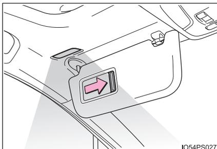
Se as luzes de cortesia permanecerem acesas quando o botão de partida for desligado, a luz se apagará automaticamente após 20 minutos.
