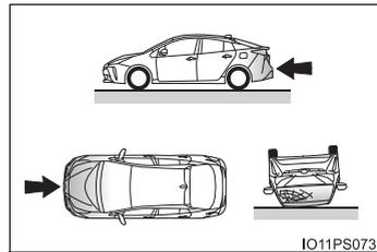
Os sistemas de airbag de cortina, em geral, não deflagram se o veículo for envolvido em uma colisão traseira, se capotar, ou ainda em caso de colisão frontal ou lateral em baixa velocidade.
