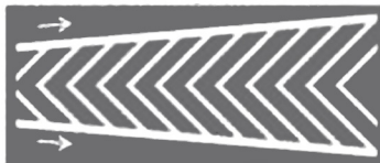
Separação de fluxo de tráfego do mesmo sentido
