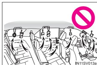
! Veículos sem sistema inteligente de entrada e partida: Não prenda acessórios pesados, duros ou pontiagudos na chave do veículo. Esses objetos podem restringir a deflagração do airbag de joelhos ou serem arremessados na direção do motorista devido à força de deflagração e, desta forma, serem perigosos.
