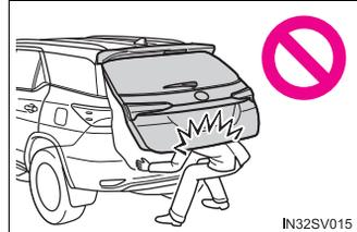
Veículos com tampa traseira elétrica: Em um acive, a tampa traseira pode fechar repentinamente se não estiver totalmente aberta. Certifique-se de que a tampa traseira está fixa antes de utilizar o compartimento de bagagem.
