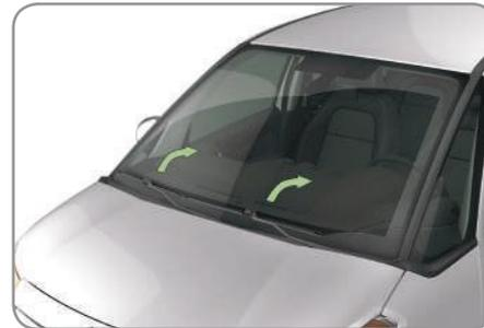
No minuto após o desligamento da ignição, qualquer ação no comando do limpador de vidro posiciona as palhetas no meio do para-brisas.
