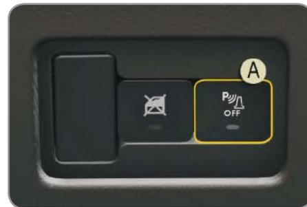
Com o motor em funcionamento, pressione o botão **A** para neutralizar definitivamente o sistema. A luz indicadora do botão acende.
