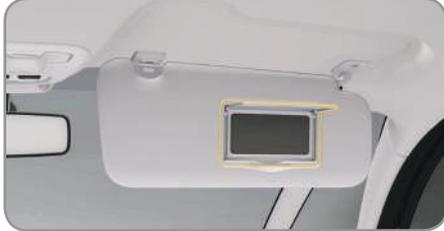
Os para-sóis encontram-se equipados com um espelho de cortesia, com tampa de ocultação.
