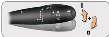
É realizado manualmente pelo condutor empurrando o comando para cima e colocando-o na posição "0".
