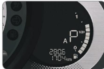
Ao deslocar a alavanca na canaleta para selecionar uma posição, a lâmpada-piloto correspondente é exibida no painel.
