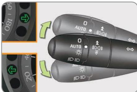
Elevar ou baixar o comando de iluminação passando o ponto de resistência; as luzes de mudança de direção correspondentes piscam até que se altere a posição.
