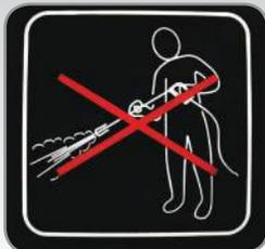
Para não danificar os componentes elétricos do veículo, é expressamente **proibido** utilizar a lavagem a alta pressão no compartimento do motor.
