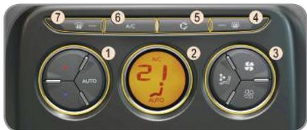
O ar condicionado só funciona com o motor em funcionamento.
