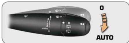
É realizada manualmente pelo condutor através de um impulso para baixo no comando para a posição "AUTO".
