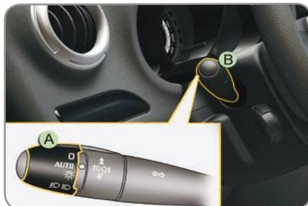
A lanterna e os faróis baixos acendem automaticamente, sem ação do condutor, em caso de detecção de baixa luminosidade exterior ou, em certos casos, em conjunto com o acionamento do limpavidros.
