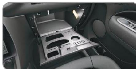
Desencaixe a tampa com uma chave de parafusos fina, para acessar à lâmpada com defeito.
