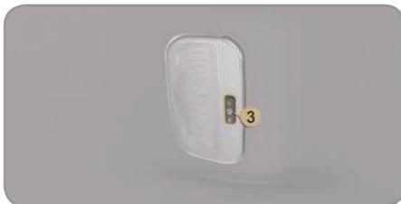
Desencaixe a tampa da luz de leitura **3** em questão com uma chave de parafusos fina, do lado do comando, para acessar à lâmpada com defeito.
