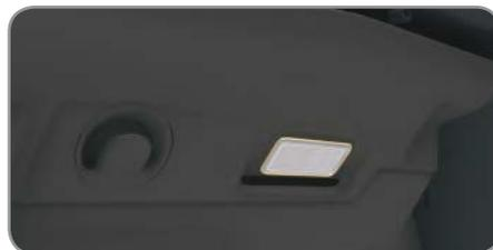
Desencaixe a tampa com uma chave de parafusos fina, para acessar à lâmpada com defeito
