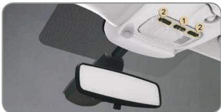
Desencaixe a tampa da luz de teto **1** com uma chave de parafusos fina, do lado do comando, para acessar a lâmpada com defeito.
