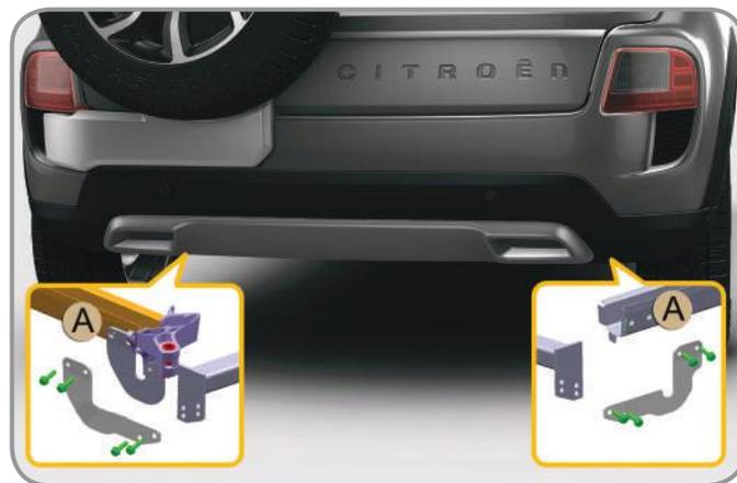
Existem pontos **A** indicados são pré-determinados para a fixação do engate nas longarinas traseiras. Eles estão cobertos por um selo e pela proteção da carroceria. Porém são facilmente detectados com auxílio de uma chave de fendas. Utilize esses pontos para a realização da fixação.
