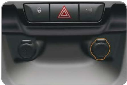
Caixa de ligação, composta por uma porta USB e uma entrada auxiliar (JACK), e encontra-se situada no porta objetos inferior. Permite ligar um equipamento portátil, tal como um equipamento portátil digital tipo iPod® ou um pen drive USB.
