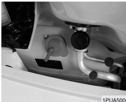
Verifique o estado e as ligações de todos os tubos do sistema de refrigeração e aquecimento. Substitua todos os tubos dilatados ou deteriorados.
