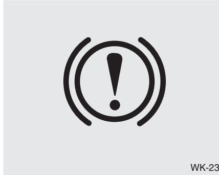
Verifique a luz avisadora do travão rodando o interruptor da ignição para a posição ON (não ligue o motor). Esta luz acende-se logo que o travão de estacionamento seja acionado através do interruptor da ignição na posição START ou ON.
