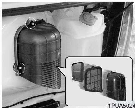
O filtro de ar do sistema de ar condicionado instalado à entrada da conduta de ar filtra as poeiras ou outras substâncias estranhas vindas do exterior que entram no veículo através do sistema de aquecimento e ar condicionado.
