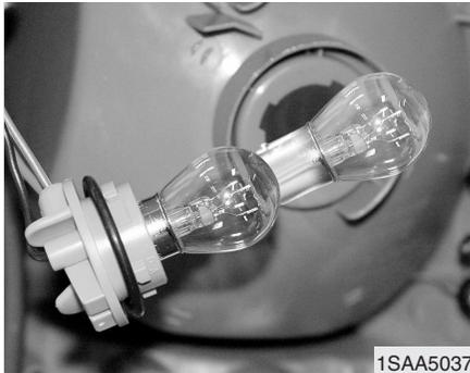
4. Retire a lâmpada da tomada pressionando-a para dentro e rodando-a até as patilhas da lâmpada ficarem alinhadas com as ranhuras da tomada. Tire a lâmpada para fora da tomada.
