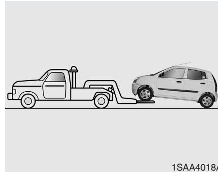
É possível rebocar o veículo com as rodas traseiras no chão (sem carrinhos) e as rodas dianteiras no ar. Se o reboque for feito por um veículo de reboque comercial e sem carrinhos nas rodas, é a frente do veículo que deve ser levantada, não a traseira.
