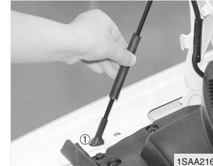
3. Levante o capô e segure-o com a haste de suporte inserindo a sua extremidade livre no respectivo orifício do capô (1).
