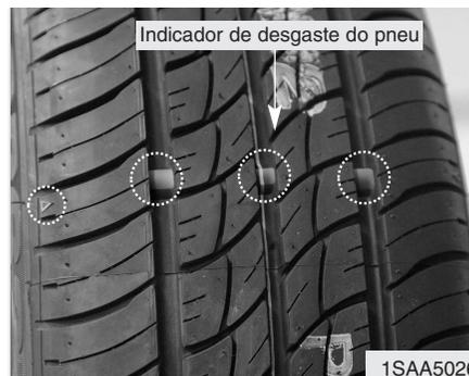
**Substituição dos pneus**
