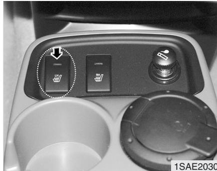
**Aquecimento do banco do condutor (quando instalado)**
