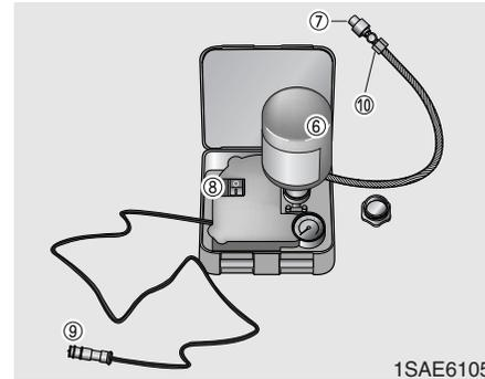
4. Enrosque bem o tubo (7) na válvula do pneu.
