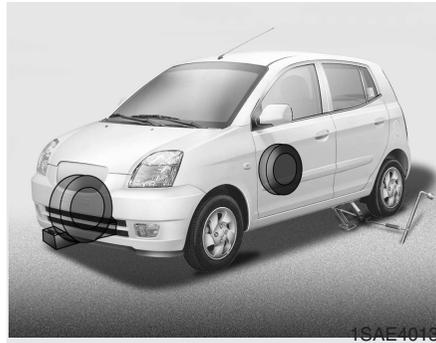
4. Retire a chave de porcas das rodas, o macaco, o rabo do macaco e o pneu sobresselente do veículo.
