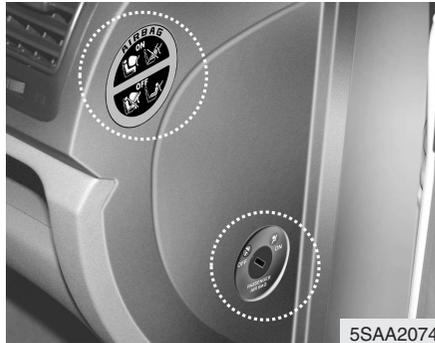
**Interruptor ON/OFF do airbag do passageiro da frente (quando instalado)**
