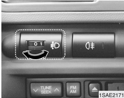
**Dispositivo de nivelamento dos faróis (quando instalado)**
