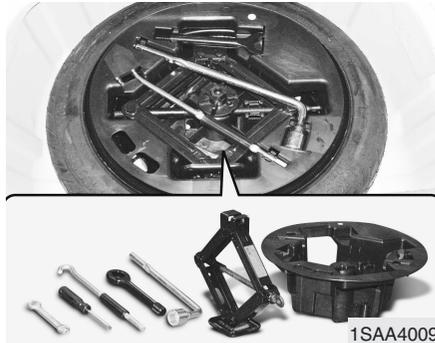
O pneu sobresselente, o macaco, o rabo do macaco, o gancho de reboque dianteiro e a chave de porcas das rodas estão guardados na bagageira. Para aceder a este equipamento, levante o tapete do piso da mala.
