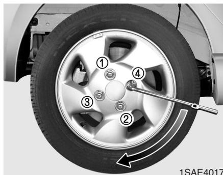
11. Depois de apertar as porcas das rodas, baixe completamente o veículo até ao chão e continue a apertar as porcas até elas ficarem devidamente fixas. Aperte bem as porcas das rodas num padrão "X". Se não tiver a certeza de que as porcas das rodas estão bem apertadas, mande inspeccioná-las na estação de serviço mais próxima. O binário de aperto especificado é de 9~11 kg•m. O mau aperto das porcas das rodas pode provocar a vibração do pedal dos travões nas travagens.
