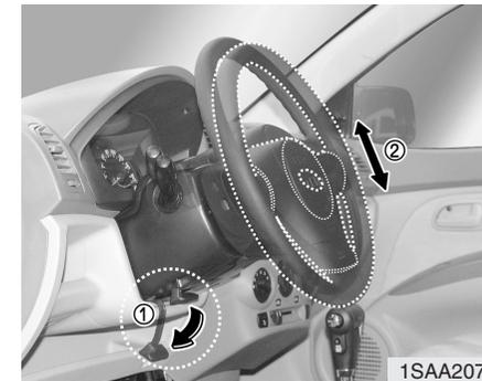
Para alterar o ângulo do volante, puxe (1) a patilha de libertação/bloqueio, regule o volante para o ângulo pretendido (2) e volte a subir a patilha para fixar o volante.
