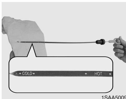
Se o líquido aquecer até uma temperatura normal de funcionamento de cerca de 70~80° C, o nível do líquido deverá situar-se na marca "HOT" ("QUENTE").
