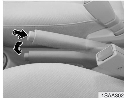
Para desengatar o travão de estacionamento, levante um pouco a alavanca, carregue no botão de desengate e, ao mesmo tempo, baixe a alavanca para a posição de descanso.
