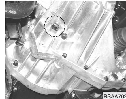
4. Retire o bujão de enchimento/inspeção no lado da caixa de velocidades.
