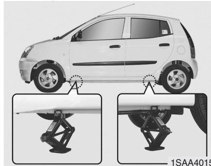
7. Coloque o macaco à frente ou atrás da posição do macaco e o mais perto possível do pneu que está a mudar. Coloque o macaco nos sítios indicados sob a carroçaria. As posições do macaco são chapas soldadas ao quadro com dois traços e um ponto levantado para indicar a colocação do macaco.
