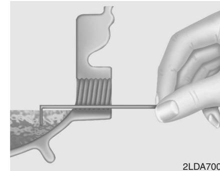
3. Verifique se o nível do óleo atinge o fundo do bocal de enchimento/inspeção. Deite o óleo necessário.
