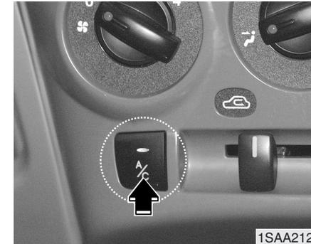
**Botão do ar condicionado (quando instalado)**
