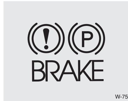
Verifique a luz de aviso do travão colocando o interruptor da ignição na posição ON (sem ligar o motor).
