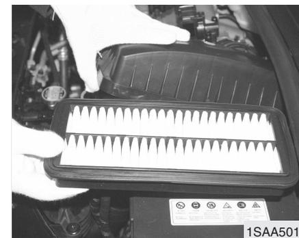
3. Substitua o elemento do filtro de ar. Recomendamos que a substituição seja feita com peças de origem Kia.
