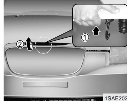
2. Vá para a frente do veículo, levante ligeiramente o capô, puxe o fecho secundário (1) no interior do centro do capô e levante (2) o capô.
