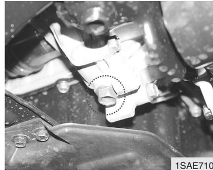
2. Retire o bujão de escoamento situado no fundo do cárter da caixa de velocidades.
