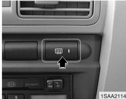
O descongelador aquece o vidro para remover gelo, nevoeiro e geada do interior e do exterior do vidro traseiro, com o motor ligado.
