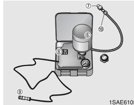
4. Enrosque o frasco rodando-o no sentido dos ponteiros do relógio para o introduzir no encaixe do frasco (6) até ficar bem apertado.
