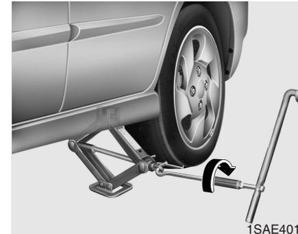
8. Introduza o rabo do macaco no macaco e rode-o no sentido dos ponteiros do relógio, levantando o veículo até o pneu ficar mesmo acima do chão, aproximadamente 30 mm. Antes de retirar as porcas das rodas, certifique-se de que o veículo está estável e que não qualquer hipótese de ele se mover ou descair.
