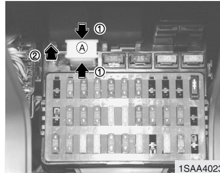
2. Puxe o fusível suspeito para fora com a ferramenta de remoção existente na tampa. Utilize a ferramenta de remoção (A).
