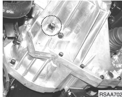
2. Retire o bujão de enchimento/inspeção no lado da caixa de velocidades.
