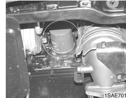
4. Retire o filtro do óleo do motor com uma chave apropriada.
