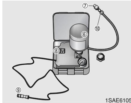
15. Se a pressão de enchimento for igual ou superior a 1,3 bar (19 psi), coloque o interruptor para ligar/desligar na posição "I" e regule a pressão de enchimento para a pressão recomendada (consulte o manual de assistência do veículo). Reduza o eventual excesso de pressão utilizando a válvula de saída de pressão (10).
