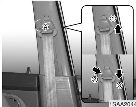
5. Regule a posição de fixação da parte do ombro de acordo com o seu tamanho (quando instalado). Para fazer subir a fixação, pressione a fixação para cima (1). Para baixar a fixação, pressione (2) o botão (A) e faça deslizar para baixo (3). Uma vez feita a regulação, certifique-se de que a fixação está bem segura.
