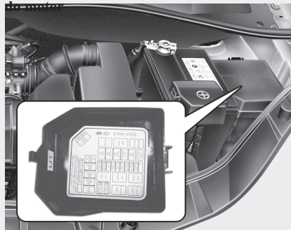
Painel secundário de fusíveis do compartimento do motor (So veículos diesel)
