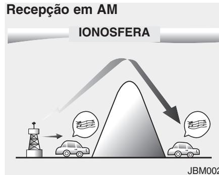
A recepção dos sinais de AM é, normalmente, melhor do que em FM. Isto deve-se ao facto das ondas de AM serem transmitidas em baixas frequências. Estas ondas longas, de baixa frequência podem seguir a curvatura da Terra, em vez de seguirem a direito para a atmosfera. Além disso, dão a volta aos obstáculos, assegurando assim uma cobertura mais perfeita.
