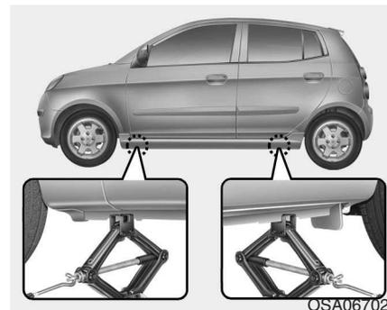
7. Coloque o macaco à frente ou atrás da posição do macaco, o mais perto possível do pneu que pretende trocar. Coloque o macaco nos locais indicados sob o quadro. As posições de colocação do macaco são placas soldadas ao quadro com duas patilhas e um ponto levantado para assentar o macaco.
