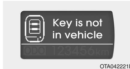
Se o dispositivo Smart Key não estiver dentro do veículo e se alguma porta for aberta ou fechada com o botão ENGINE START/STOP na posição ACC, ON, ou START, a luz avisadora acende-se no visor LCD. O sinal sonoro soa durante 5 segundos sempre que o dispositivo Smart Key não se encontra dentro do veículo e a porta está fechada.
