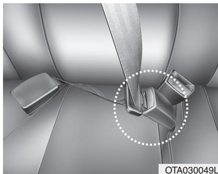
Para colocar o cinto de segurança traseiro central, tem de se utilizar a fivela com a marca "CENTER" (Se instalado).
