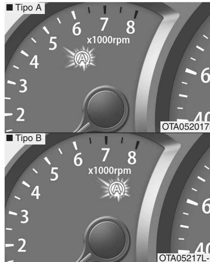
O motor pára e a luz verde indicadora do sistema AUTO STOP (Paragem Automática do Veículo) ((A)) acende-se no painel de instrumentos.
