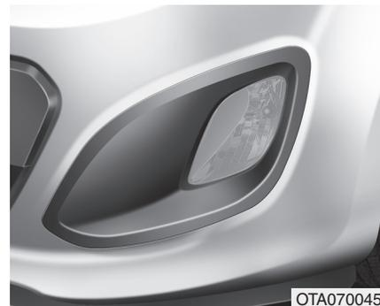
***Farol de nevoeiro dianteiro ou DRL ou farol de nevoeiro dianteiro + DRL (se instalado)***
