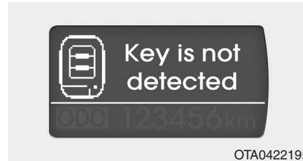
Se o dispositivo Smart Key não estiver dentro do veículo ou não for detectado e se o botão ENGINE START/STOP for pressionado, acende-se um aviso no visor LCD durante 10 segundos.
