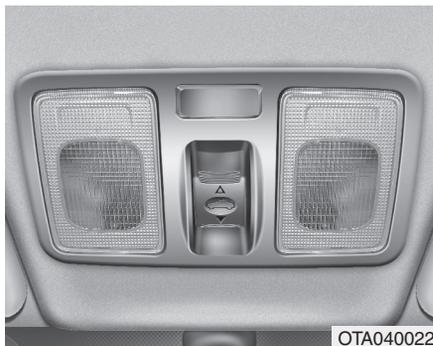
Se o seu veículo estiver equipado com um tecto de abrir, pode fazê-lo deslizar ou incliná-lo com o manípulo de comando situado na consola superior.
