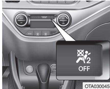
**Indicador de desactivação "OFF" do airbag frontal do passageiro (se instalado)**
