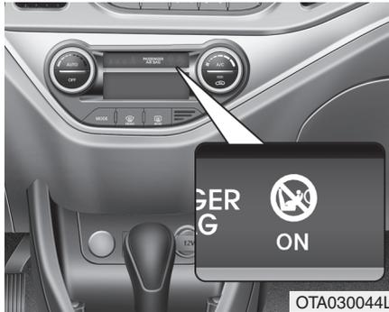
**Indicador de activação "ON" do airbag frontal do passageiro (se instalado)**
