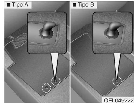
**Gancho(s) de fixação dos tapetes (se instalado)**
