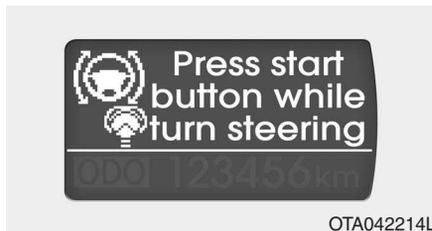
Se ao pressionar o botão ENGINE START/STOP o volante não desbloquear normalmente, a luz avisadora acende-se no visor LCD durante 10 segundos.
