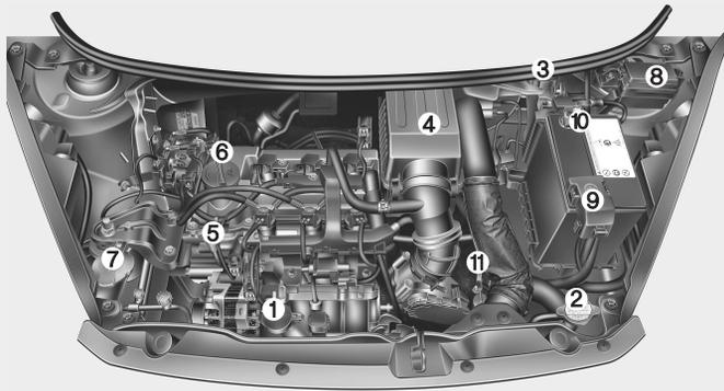
1. Depósito do líquido de refrigeração do motor .....7-28
