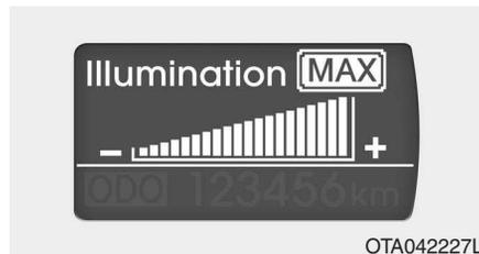
A intensidade luminosa do painel de instrumentos é indicada quando se procede à respectiva regulação com o interruptor de controlo da iluminação.
