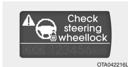
Se o volante não bloquear normalmente quando o botão ENGINE START/ STOP roda para a posição OFF, a luz avisadora acende-se no visor LCD durante 10 segundos. Além disso, o sinal sonoro toca durante 3 segundos e o a luz do botão ENGINE START/STOP pisca durante 10 segundos.
