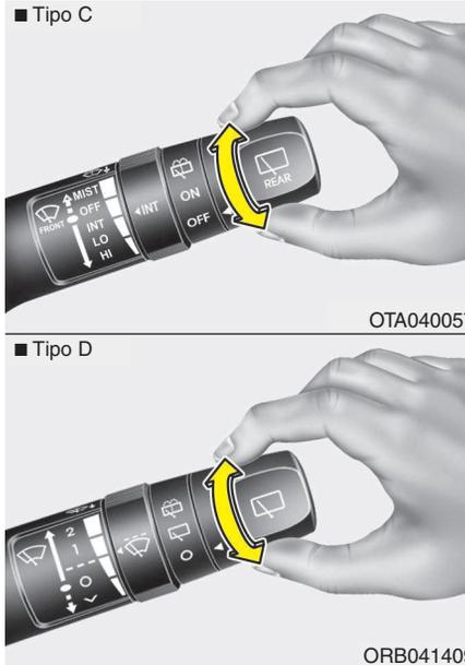
**Interruptor do borrifador e limpa-vidros traseiro (se instalado)**
