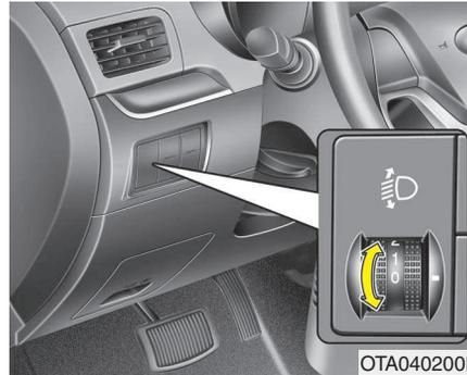
**Dispositivo de nivelamento dos faróis (se instalado)**
