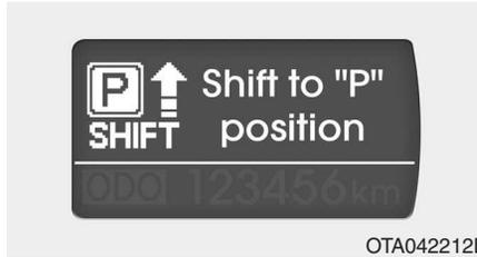
Se tentar desligar o motor sem o selector de mudanças na posição P (park), o botão ENGINE START/STOP roda para a posição ACC. Se premir mais uma vez o botão, este regressa à posição ON. A luz avisadora acende-se no visor LCD durante aproximadamente 10 segundos para indicar que deve pressionar o botão ENGINE START/ STOP com o selector de mudanças na posição P (park).
