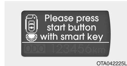
Se pressionar o botão de ENGINE START/STOP enquanto está iluminado o aviso "Smart Key Não Detectada", surge durante 10 segundos no visor LCD a mensagem (Premir Start com Smart Key). Além disso, a luz indicadora do imobilizador de arranque pisca durante 10 segundos.
