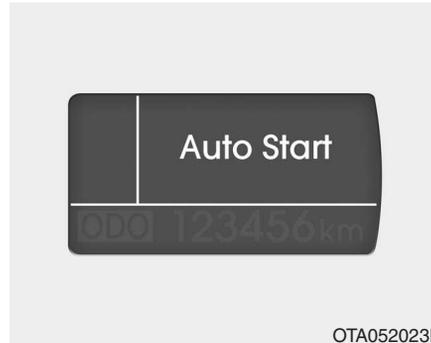
A luz indicadora verde do sistema AUTO STOP ((A)) do painel de instrumentos pisca durante 5 segundos e o respectivo aviso “Voltar a Ligar Motor” aparece no visor LCD (se instalado).
