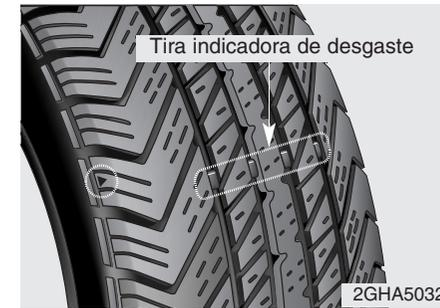
**Substituição dos pneus**
