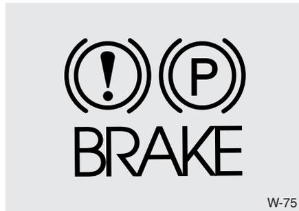
Verifique a luz avisadora dos travões rodando a chave da ignição para ON (não ponha o motor a trabalhar). Esta luz avisadora acende-se quando o travão de estacionamento se encontra engatado com a chave da ignição nas posições START ou ON.
