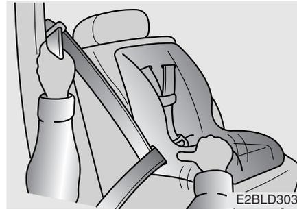
4. Afivela o cinto de segurança e dê-lhe alguma folga. Depois da instalação, tente mover o sistema de retenção em todas as direcções para ter a certeza de que ficou seguramente instalado.
