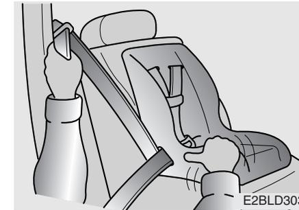
4. Afivele o cinto de segurança e dê-lhe alguma folga. Depois da instalação, tente mover o sistema de retenção em todas as direcções para ter a certeza de que ficou seguramente instalado.
