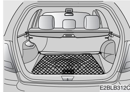
Quando você levar materiais no compartimento de carga, você pode segurá-los com a rede de carga para evitar movimentos. Coloque os ganchos da rede de carga nas quatro argolas do compartimento de carga.
