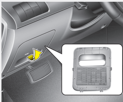
Painel de fusíveis interior
