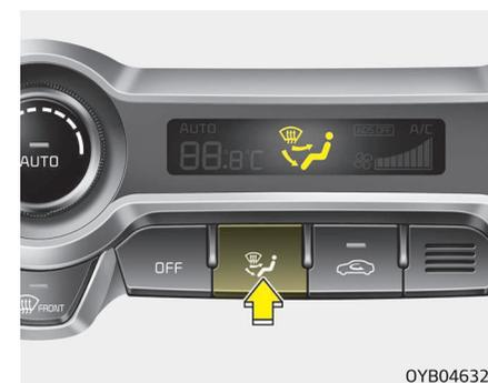
O botão de seleção de modo controla a direção do fluxo de ar através do sistema de ventilação.
