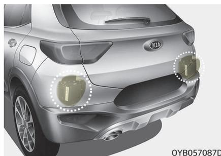
Os sensores estão localizados no interior do para-choques traseiro. Mantenha o para-choques traseiro sempre limpo para que o sistema possa funcionar corretamente.
