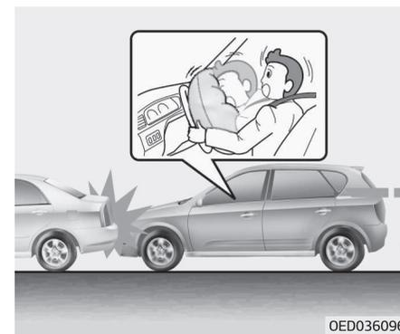
Os airbags dianteiros foram concebidos para encher em caso de colisão frontal, em função da intensidade, da velocidade ou dos ângulos de impacto dessa colisão.
