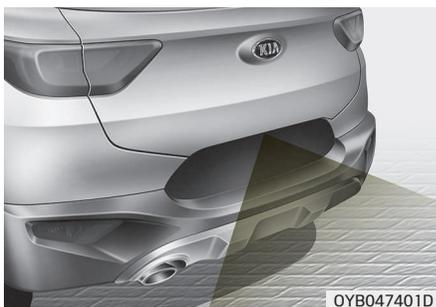
A câmara traseira fica ativa com a luz de marcha-atrás acesa, o interruptor da ignição ligado e a alavanca da caixa de velocidades na posição R (marcha atrás).
