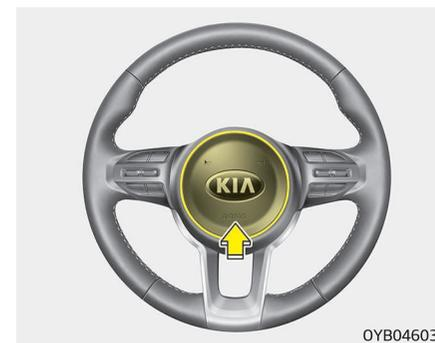
Para fazer soar a buzina, carregue no símbolo da buzina existente no volante. Experimente a buzina regularmente para ter a certeza de que está a funcionar devidamente.
