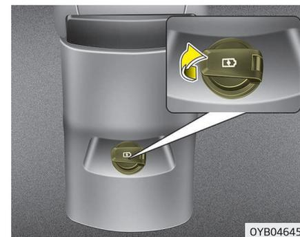
O carregador USB foi concebido para recarregar pilhas de pequenos aparelhos elétricos através de um cabo USB. Os aparelhos elétricos podem ser recarregados quando o botão ENGINE START/STOP (ligar/desligar o motor) estiver na posição ACC/ON/START. O estado de carga da bateria pode ser controlado no aparelho elétrico.
