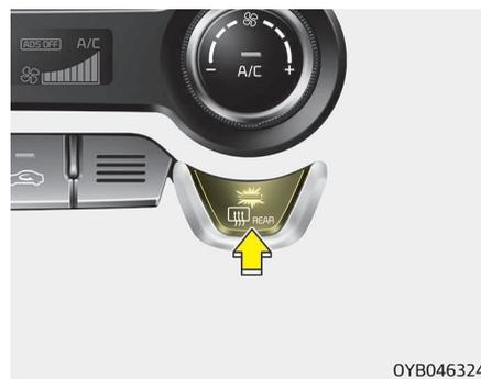
Com o motor a trabalhar, o desembaciador aquece o vidro traseiro para remover gelo, humidade e geada. Para ativar o desembaciador do vidro traseiro, carregue no respetivo botão. O indicador luminoso do botão acende-se com a ativação do desembaciador. Se existir uma forte acumulação de neve no vidro traseiro, limpe-a antes de acionar o desembaciador.
