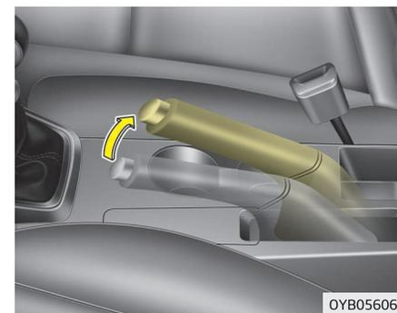
Para acionar o travão de estacionamento, carregue no pedal dos travões e puxe a alavanca do travão de estacionamento completamente para cima.
