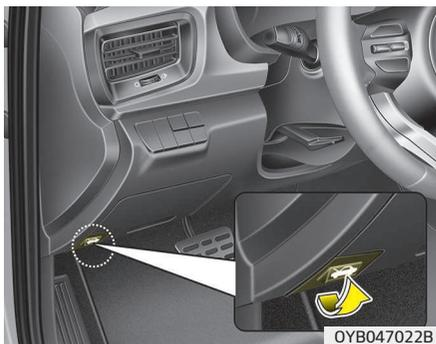
1. Puxe a alavanca de abertura para desengatar o capô. O capô levanta-se ligeiramente.
