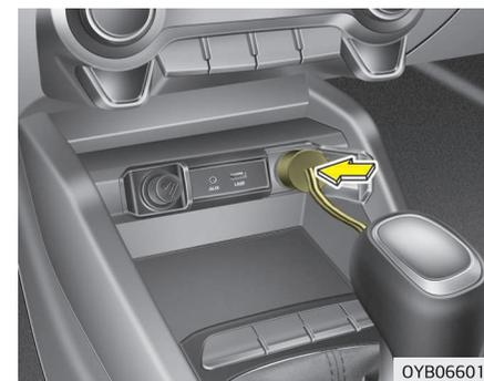
9. Faça a ligação entre o compressor e a tomada elétrica do veículo, usando os cabos e conectores.
