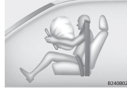
Os módulos dos airbags estão localizados no centro do volante e no painel do lado do passageiro por cima do porta-luvas. Se o módulo SRSCM detetar um impacto suficientemente forte na dianteira do veículo, ativará automaticamente os airbags dianteiros.
