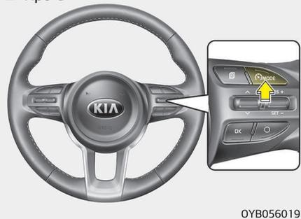
1. Prima o botão de velocidade de cruzeiro /CRUISE/CRUISE MODE no volante para ligar o sistema. A luz indicadora sistema de controlo da velocidade ilumina-se.
