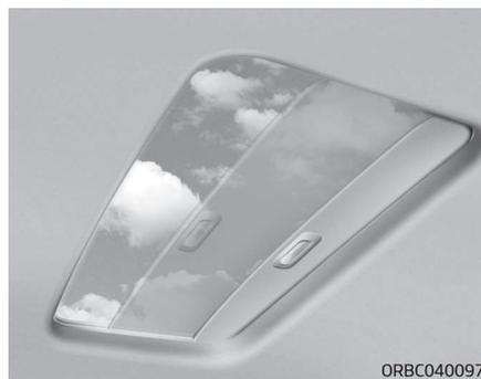
A cortina para o sol é aberta automaticamente quando deslizar o painel de vidro. Para a fechar, deve fazê-lo manualmente.
