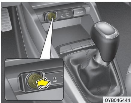
Para o isqueiro funcionar, o interruptor da ignição tem de estar na posição ACC ou ON.
