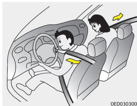
O seu veículo está equipado com cintos de segurança com pré-tensores nas posições das partes laterais dos bancos dianteiros e traseiros. O objetivo dos pré-tensores é garantir que os cintos de segurança prendem os ocupantes dos bancos eficazmente e com firmeza em determinadas situações de colisão. Os pré-tensores dos cintos de segurança podem ser ativados juntamente com os airbags, se o nível de gravidade do embate o justificar.
