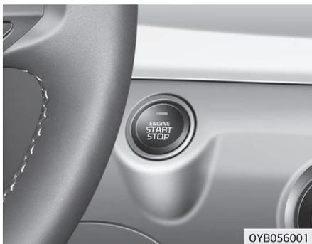
Sempre que a porta dianteira é aberta, o botão ENGINE START/STOP (ligar/desligar o motor) acende-se, para sua comodidade. A luz apaga-se cerca de 30 segundos depois do fecho da porta. Também desliga automaticamente quando o sistema de alarme antirroubo é ativado.
