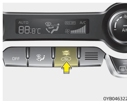
Utiliza-se para seleccionar a posição de ar exterior (fresco) ou a posição de recirculação do ar. Para mudar a posição do comando da entrada de ar, carregue no botão de controlo.
