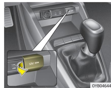
A tomada elétrica destina-se a fornecer energia elétrica a telemóveis ou outros aparelhos concebidos para funcionar com sistemas elétricos de automóveis. Os aparelhos devem ter uma capacidade inferior a 10 amperes com o motor ligado.
