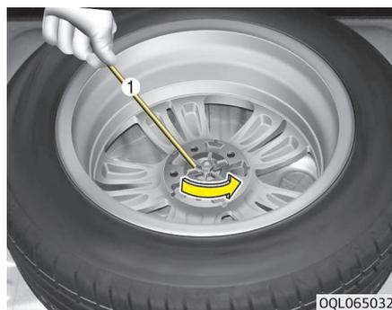
Se tiver dificuldades em desapertar a porca de fixação do pneu à mão, pode soltá-la facilmente usando a manivela do macaco.
