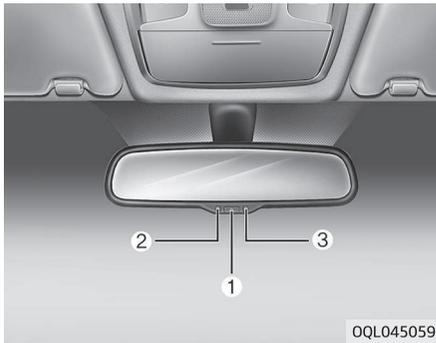
Em situações de condução noturna ou fraca luminosidade, o espelho retrovisor elétrico controla automaticamente o brilho proveniente dos faróis do veículo que segue atrás de si. O sensor (3) colocado no espelho deteta o nível de luz à volta do veículo e, por meio de uma reação química, controla automaticamente o brilho dos faróis dos veículos que seguem no seu encaço.
