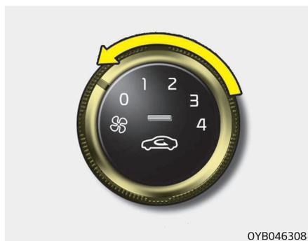
Para desligar os ventiladores, desligue o botão de comando da velocidade da ventoinha, colocando-o na posição "0".
