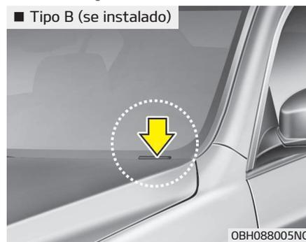
O VIN (Número de Identificação do Veículo) está também gravado numa chapa fixa na parte superior do painel de instrumentos. O número gravado na chapa pode facilmente ser visualizado do exterior através do para-brisas.
