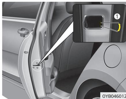
Se o botão de travagem das portas não funcionar eletronicamente, a única forma de trancar a(s) porta(s) é utilizando a chave metálica a partir da respetiva ranhura exterior.
