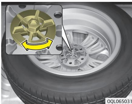
Rode a porca de fixação no sentido contrário ao dos ponteiros do relógio. Instale o pneu pela ordem inversa da remoção. Para impedir que o macaco produza ruídos durante o andamento do veículo, arrume-o devidamente.
