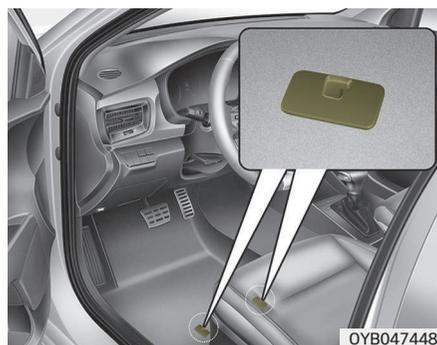
Quando utilizar tapetes no piso dianteiro, certifique-se de que o(s) fixa ao(s) ponto(s) de fixação do seu veículo. Esta fixação impede os tapetes de deslizarem para a frente.
