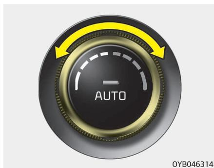
A temperatura aumenta até ao máximo (HI) quando se roda o botão de comando totalmente para a direita. A temperatura diminui até ao mínimo (Lo) quando se roda o botão de comando totalmente para a esquerda. Quando se roda o botão, a temperatura aumenta ou diminui em patamares de 0,5°C. Quando regulado para a temperatura mais baixa, o sistema de climatização funciona continuamente.
