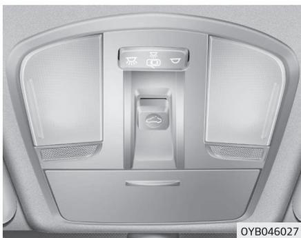
Se o seu veículo vier equipado com um teto de abrir, poderá abrir, fechar ou inclinar este último através do respetivo interruptor de controlo, localizado na consola no teto.
