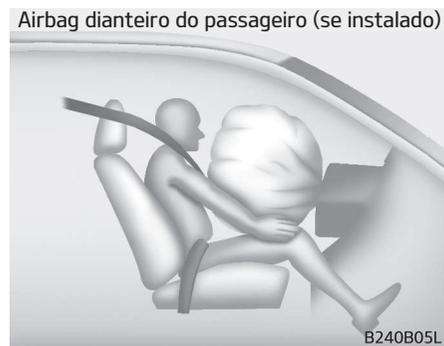
O enchimento total de um airbag, juntamente com a atuação de um cinto de segurança corretamente colocado, atenua o movimento para a frente do condutor ou do passageiro da frente, reduzindo o risco de lesões na cabeça e no tórax.
