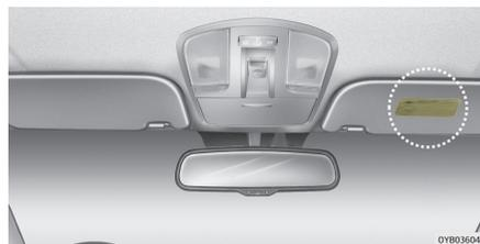
As etiquetas de aviso dos airbags destinam-se a alertar o condutor e os passageiros dos riscos potenciais do sistema dos airbags.
