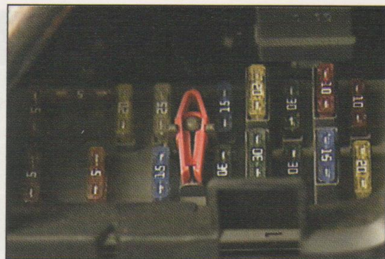
F.A. Localização da caixa de fusíveis interna: no lado do motorista próximo do volante.
