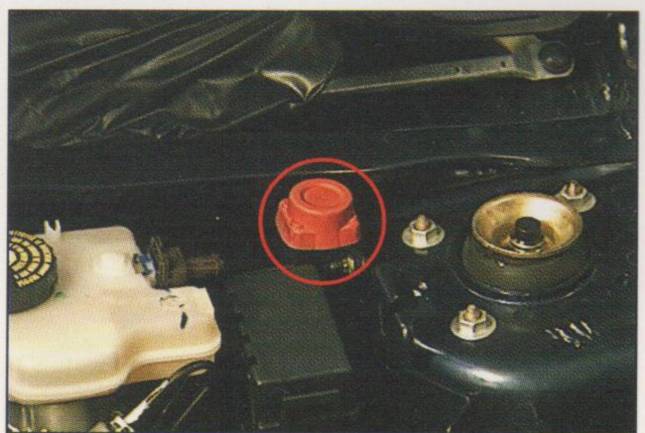
F.D. Localização do interruptor inercial (II): alojado no compartimento do motor, próximo ao suporte do amortecedor esquerdo.
