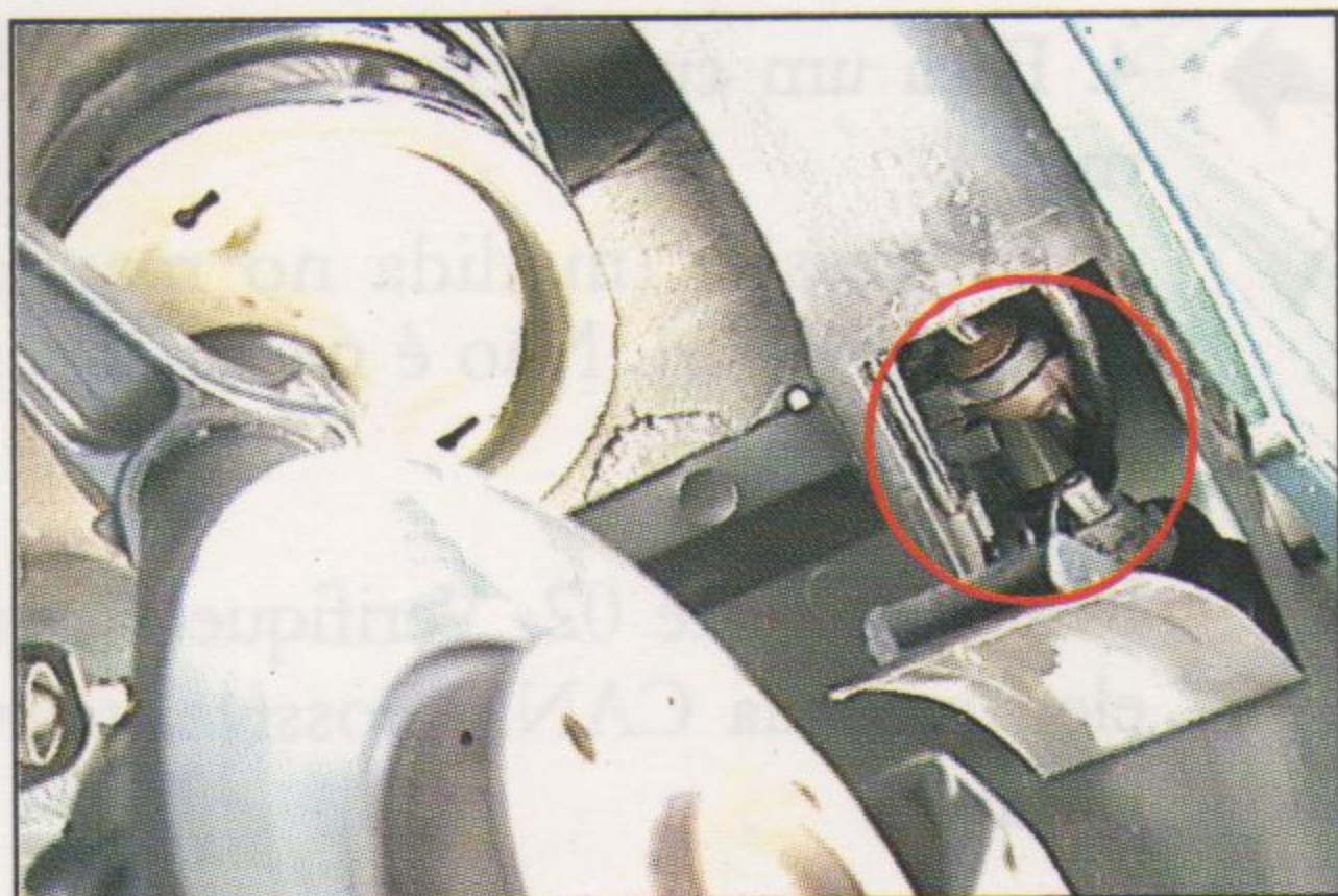
F.A. Localização da eletroválvula CANP: dentro do paralamas dianteiro direito.
