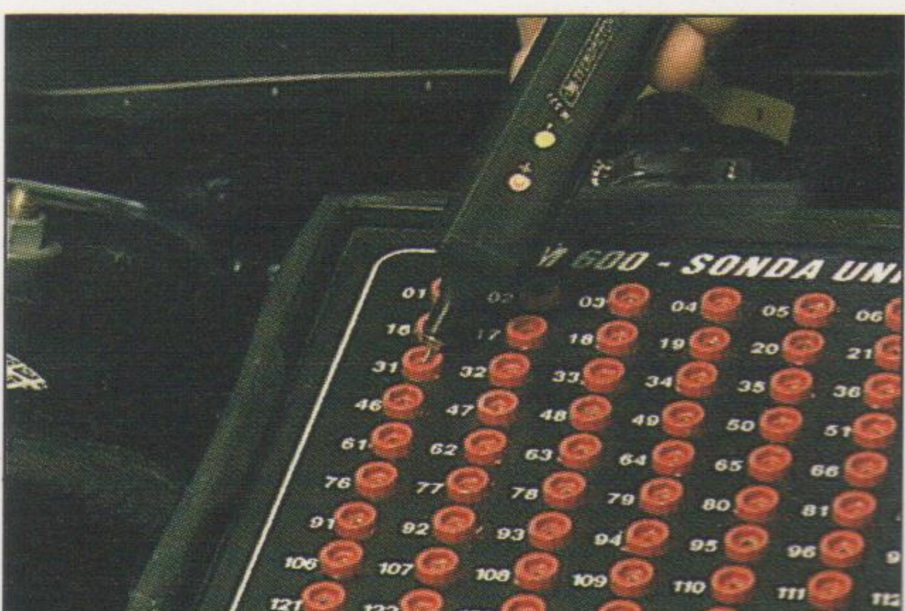
F.02.2b. Polaridade do interruptor de mínima com o acelerador em repouso usando a sonda universal.
