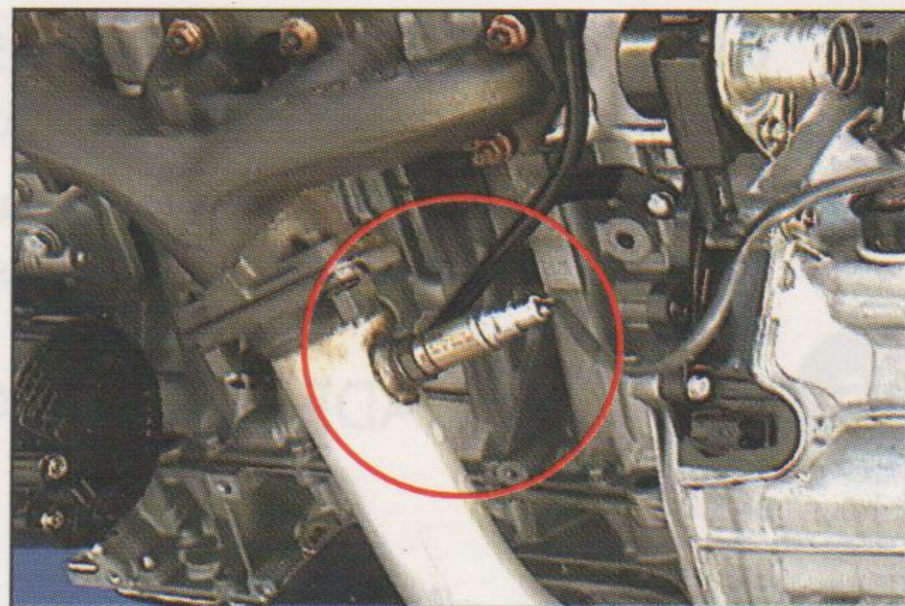
F.A. Localização do sensor de oxigênio: Fixado ao tubo primário de descarga.
