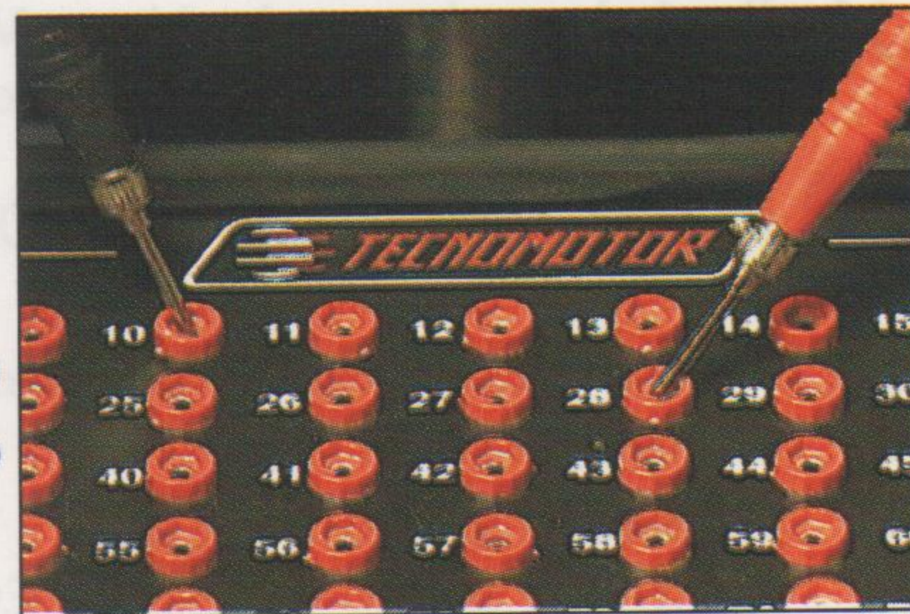
F.01.1b. Medida de tensão de resposta do sensor HEGO pela sonda universal.
