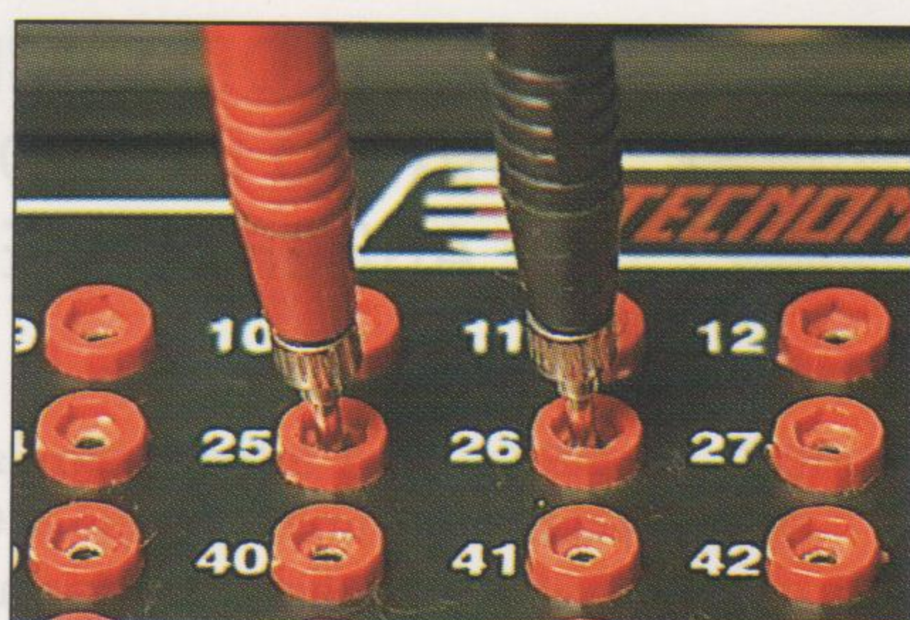
F.01.2b. Medida da tensão de resposta do sensor ECT com o auxílio da sonda universal.
