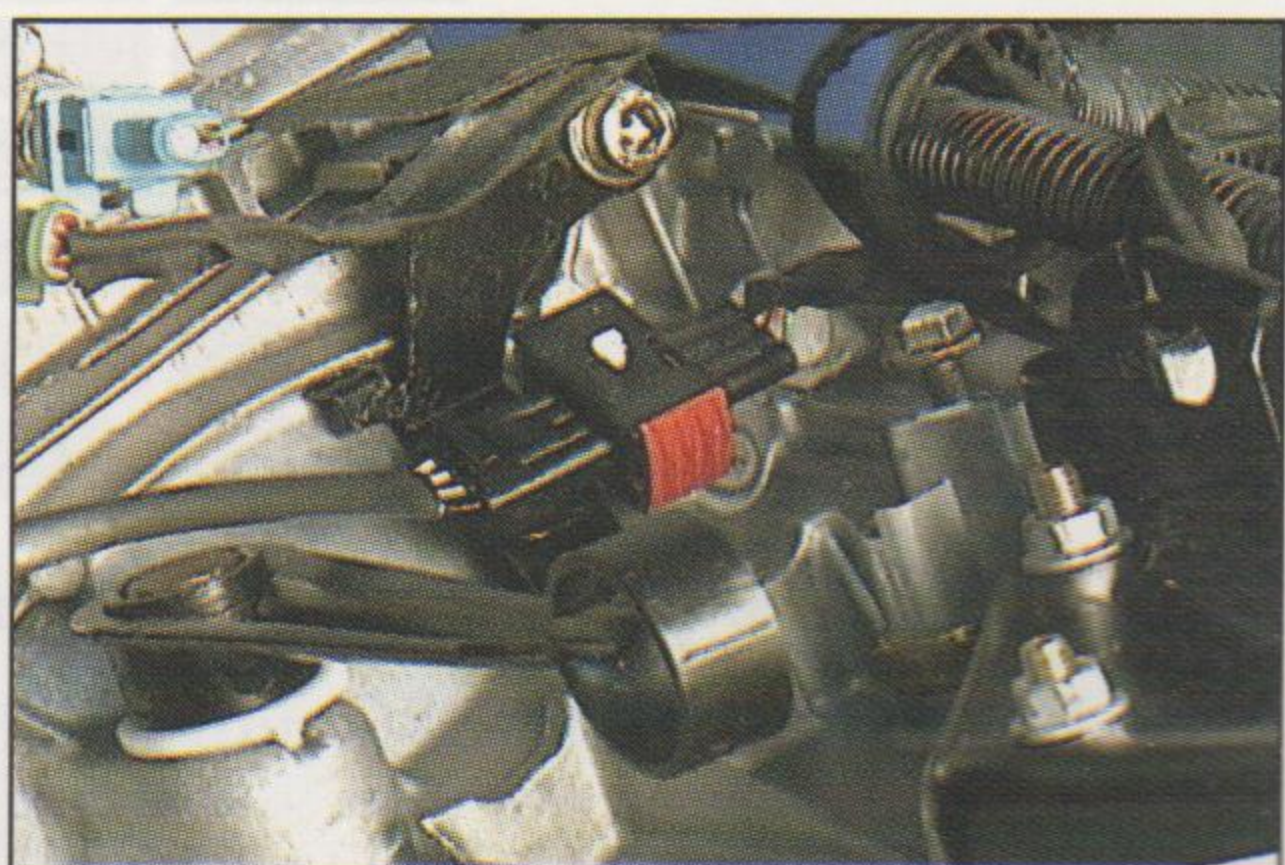
F.C. Localização do terminal elétrico do sensor HEGO.
