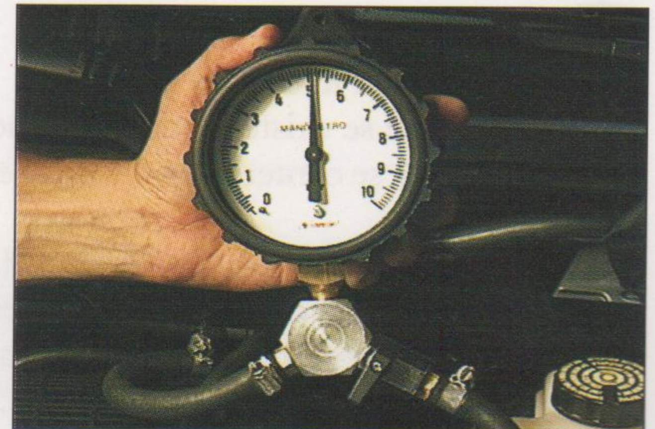
F.01.03. Válvula de estrangulamento do manômetro fechada.
