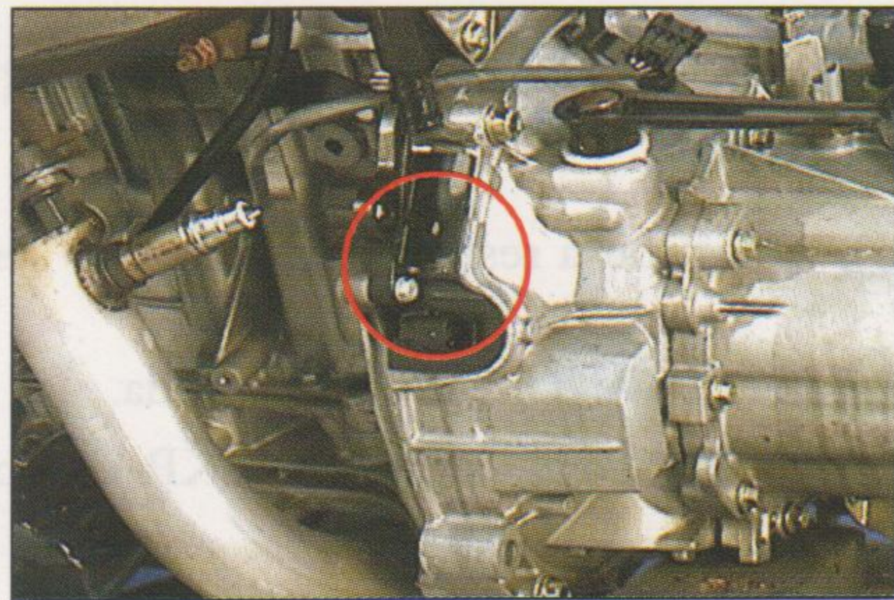
F.A. Localização do sensor CKP: próximo ao volante do motor.
