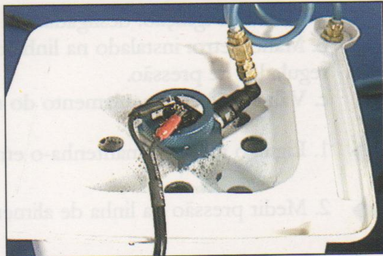
F.05.07. Limpeza do eletroinjetor no TM-503.
