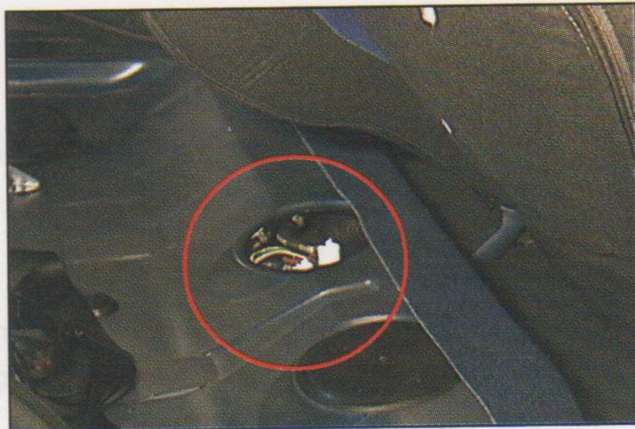
F.A. Localização da bomba de combustível: debaixo do banco transeiro (debaixo da tampa de borracha).
