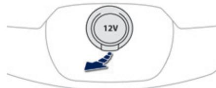
☞ Para ligar um acessório de 12 V (potência máxima: 120 Watts), eleve a tampa e ligue o adaptador adequado.
