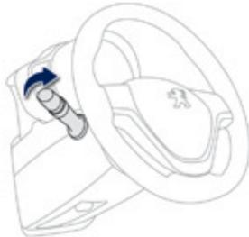
Manutenção temporária da iluminação das luzes de cruzamento, após desligar a ignição do veículo, que facilita a saída dos ocupantes do veículo em caso de fraca luminosidade.
