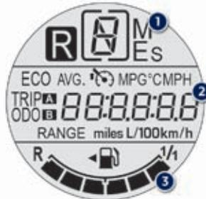
1. Posição da alavanca de velocidades e velocidade engrenada.
