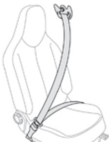
Os cintos de segurança dianteiros encontram-se equipados com um sistema de pré-tensão pirotécnica e limitador de esforço.
