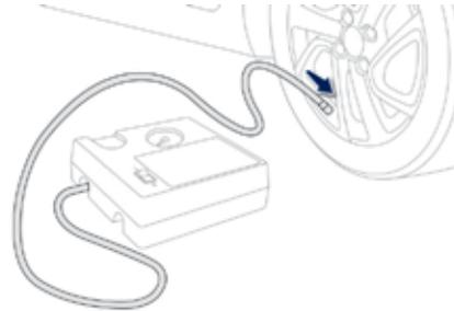
Pode utilizar igualmente o compressor, sem injeção de produto, para controlar ou encher ocasionalmente os pneus.
