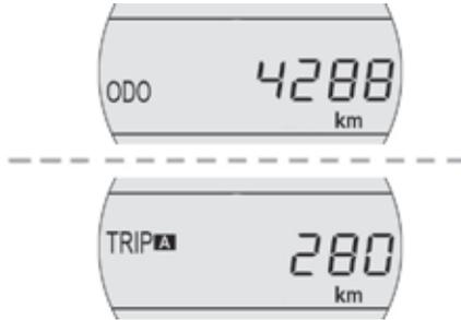
Após ter ligado a ignição, o conta-quilómetros seleccionado aquando da paragem do veículo é apresentado.
