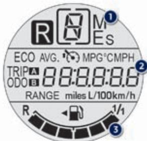
1. Posição do selector de velocidades e velocidade engrenada.
