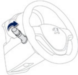
Manutenção temporária da iluminação das luzes de cruzamento, após desligar a ignição do veículo, que facilita a saída dos ocupantes em caso de fraca luminosidade.
