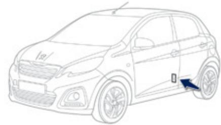
É necessário inicializar o sistema após cada ajuste da pressão de um ou vários pneus e após a substituição de uma ou várias rodas. Uma etiqueta colada no pilar central, do lado do condutor, lembra-o desta operação.
