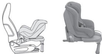
É instalada “de costas para a estrada” através de uma base ISOFIX que é fixa às argolas **A**. A base inclui uma perna de suporte regulável em altura que assenta no chão do veículo.
