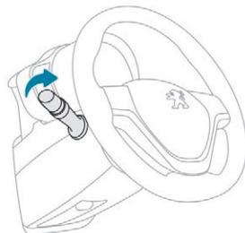
Mantém as luzes de cruzamento temporariamente acesas, após desligar a ignição do veículo, o que facilita a saída dos ocupantes em caso de fraca luminosidade.
