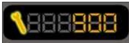
5 segundos depois de ligada a ignição, o conta-quilómetros passa ao funcionamento normal e a chave permanece acesa.
