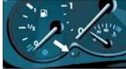
Com os faróis acesos, carregar no botão para variar a intensidade da iluminação do posto de condução. Quando a iluminação atingir o ajuste mínimo (ou máximo), soltar o botão e em seguida tornar a carregar para aumentá-la (ou diminuí-la). Quando a iluminação atingir a intensidade pretendida, soltar o botão.
