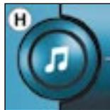
Efectuar pressões sucessivas na tecla **H** para aceder aos ajustes dos graves (**BASS**), dos agudos (**TREB**), do loudness (**LOUD**), do fader (**FAD**), do balanço
