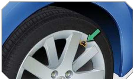
Sensores montados em cada válvula lançam o alarme em caso de anomalia (velocidade superior a 20 km/h).
