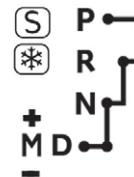
Com uma **caixa de velocidades automática**, coloque o seletor de velocidades em **P** ou **N** e depois pressione a fundo o pedal do travão.
