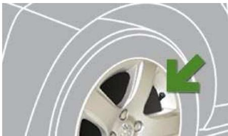
Sensores montados em cada válvula lançam o alarme em caso de anomalia (velocidade superior a 20 km/h).
