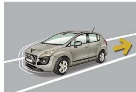
**Em descidas, com o veículo imobilizado e marcha-atrás engrenada, este é mantido durante um curto período de tempo, aquando da libertação do pedal de travão.**
