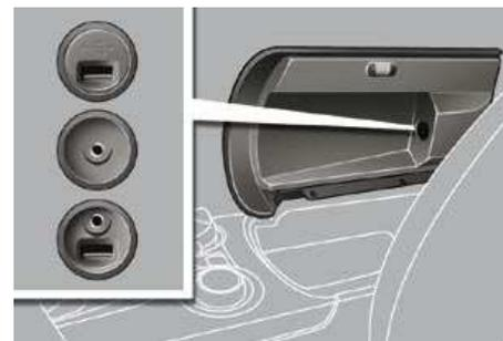
Esta caixa de ligação, composta por uma tomada JACK e/ou USB, encontra-se no apoio de braços dianteiro (sob a tampa).
