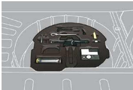
Sistema completo composto por um compressor e um frasco de produto de colmatagem, que permite uma **reparação temporária** do pneu, de modo a dirigir-se à oficina mais próxima.
