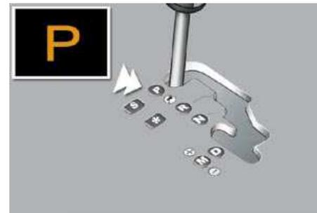
Ao deslocar a alavanca na grelha para seleccionar uma posição, acende-se o respectivo indicador no quadro de bordo.
