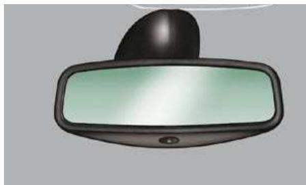
Para evitar o encandeamento, o espelho retrovisor interior escurece automaticamente em função da intensidade luminosa proveniente da traseira.
