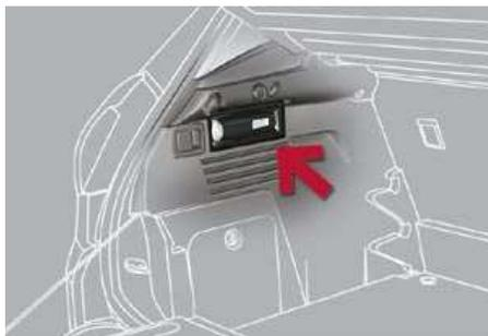
Iluminação amovível, integrada na parede da mala, para servir de iluminação de mala e de lâmpada de bolso.
