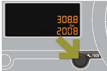
As quilometragens totais e diárias são visualizadas durante trinta segundos ao desligar o motor, à abertura da porta do condutor, bem como ao trancamento e destrancamento do veículo.
