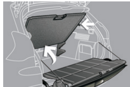
A partir da posição alta, colocar o piso nessa posição (inclinado). É suportado por dois batentes, de modo a aceder à parte inferior ou à roda sobresselente.
