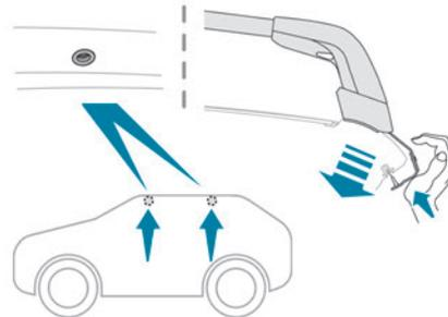
As barras transversais devem ser fixadas apenas nos quatro pontos de fixação situados na armação do tejadilho. Estes pontos estão tapados pelas portas do veículo quando estas estão fechadas. As fixações das barras do tejadilho têm um perno que deve ser inserido na abertura de cada ponto de fixação.
