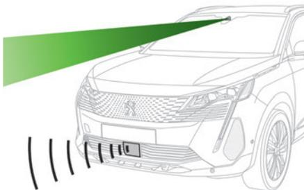
O veículo possui uma câmara situada na parte superior do para-brisas e, de acordo com a versão, um radar situado no para-choques dianteiro.
