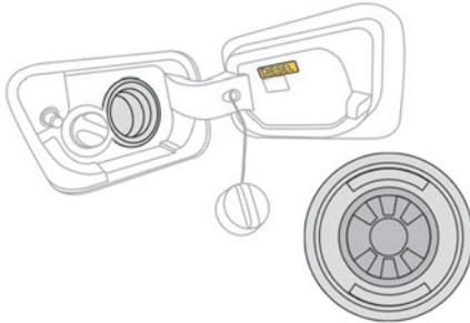
Aquando da introdução de uma pistola de gasolina no bocal de abastecimento de combustível de um veículo a diesel, ela entra em contacto com a aba. O sistema permanece fechado e impede o respetivo enchimento.
