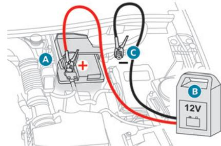
▶ Desligue o carregador **B** antes de ligar os cabos à bateria, para evitar qualquer faísca perigosa.
