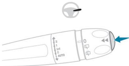
▶ Pressione e mantenha pressionado o botão situado na extremidade do comando de iluminação do limpador de vidros.
