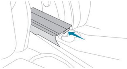
▶ Pressione a alavanca por baixo da tampa. A tampa abre-se em duas partes.
