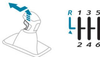
► Eleve a patilha sob o botão rotativo e desloque a alavanca de velocidades para a esquerda e, em seguida, para a frente.
