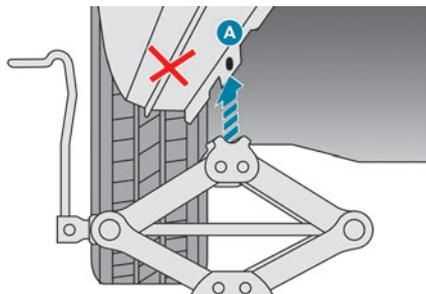
► Eleve o macaco **6** até que a sua cabeça esteja em contacto com a posição **A** ou **B** utilizada; a área de contacto **A** ou **B** no veículo deve ficar bem inserida na parte central da cabeça do macaco.
