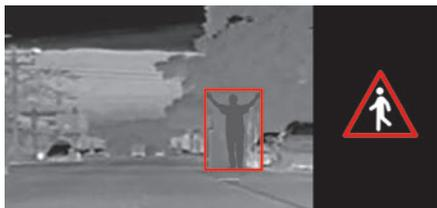
O alcance de deteção da câmara situa-se entre 15 m (para peões) e 200 m, dependendo das condições de visibilidade.
