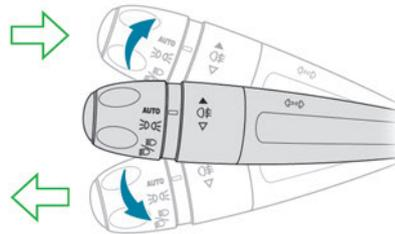
▶ Esquerda ou direita: desloque o comando de iluminação para baixo ou para cima até passar o ponto de resistência.
