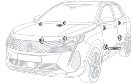
O veículo está equipado com um sistema acústico de alta fidelidade da marca francesa FOCAL®. 10 altifalantes equipados com as tecnologias exclusivas FOCAL® proporcionam o prazer de um som puro e bem definido a bordo do veículo:
