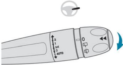
▶ Para seleccionar a velocidade de limpeza: eleve ou baixe o comando para a posição pretendida.
