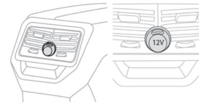
▶ Para ligar um acessório de 12 V (potência máxima: 120 W), levante a tampa e ligue o adaptador adequado.
