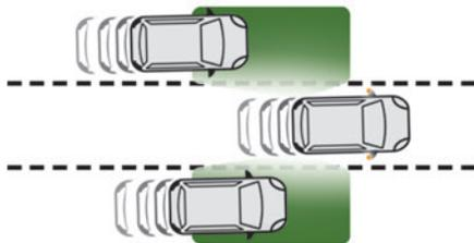
Este sistema avisa o condutor da presença potencialmente perigosa de outro veículo (automóvel, camião, motociclo) nos ângulos mortos do veículo (áreas ocultas no campo de visão do condutor) através dos sensores situados nas partes laterais dos para-choques.
