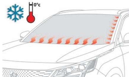
Com tempo frio, este sistema aquece a base do para-brisas, bem como a área situada ao longo da moldura esquerda do para-brisas.
