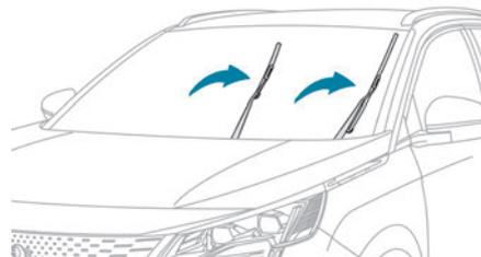
A utilização do comando do limpa-vidros um minuto depois de desligar a ignição vai colocar as escovas do limpa-vidros na vertical.
