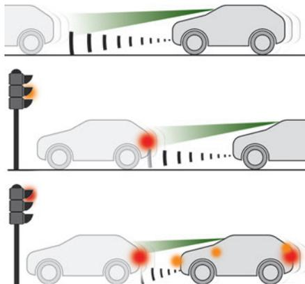
Esta função, também apelidada de “travagem automática de emergência”, intervém depois do sinal sonoro se o condutor não acionar o pedal do travão de imediato.
