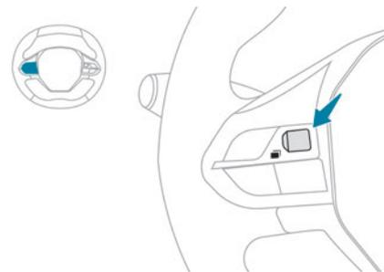
▶ Rode o botão situado à esquerda do volante para visualizar e percorrer os vários modos na parte direita do quadro de bordo.
