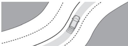
O sistema identifica os limites da faixa de rodagem e direciona o veículo para mantê-lo dentro desta faixa e mantém a posição lateral escolhida pelo condutor. Para tal, o sistema utiliza uma câmara, situada na parte superior do para-brisas.
