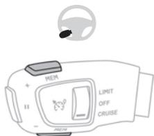
Com este botão pode selecionar uma velocidade de referência memorizada para utilizar com o limitador de velocidade ou o regulador de velocidade programável.
