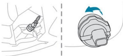
Estas lâmpadas são substituídas a partir do exterior do para-choques traseiro.
