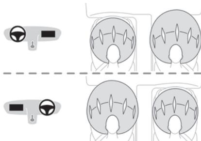
Sistema que protege o condutor e o passageiro dianteiro no caso de impacto dianteiro grave, limitando o risco de ferimentos na cabeça e no peito. O airbag do condutor está integrado no centro do volante; o airbag do passageiro dianteiro encontra-se no painel de bordo por cima do porta-luvas.
