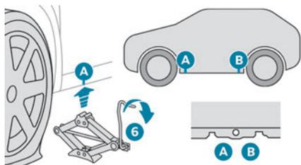
► Posicione a base do macaco **6** no chão e assegure-se de que esta se encontra diretamente por baixo do ponto de fixação dianteiro **A** ou traseiro **B** marcado na parte inferior da carroçaria, aquele que estiver mais próximo da roda a substituir.
