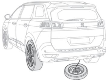
A roda sobresselente é fixada por um sistema de guincho por trás da traseira do veículo.
