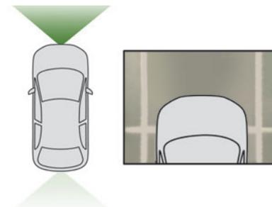
A câmara regista as zonas à volta do veículo durante a manobra para reconstituir uma imagem a partir do topo dianteiro do veículo no ambiente em que se encontra, permitindo realizar a manobra do veículo evitando os obstáculos circundantes. Esta vista está disponível com o modo AUTO ou no menu de seleção de vista.
