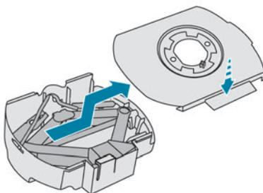
A caixa de ferramentas está instalada no centro da roda sobresselente, por baixo do veículo.
