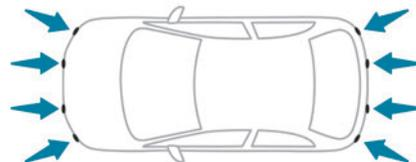
Este sistema deteta e assinala a proximidade de obstáculos (por exemplo, peões, veículos, árvores, barreiras) através de sensores situados no para-choques.
