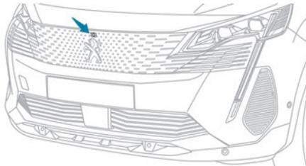
Este sistema identifica e assinala a presença de peões e animais no campo de visão do condutor, em condições reduzidas de iluminação exterior,
