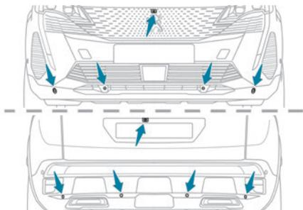
Com o motor a funcionar, estes sistemas permitem visualizar imagens das zonas à volta do seu veículo no ecrã tátil, utilizando uma câmara para Visiopark 1 e duas câmaras para Visiopark 2.
