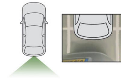
A câmara regista a área à volta do veículo durante a manobra para reconstituir uma imagem a partir da parte traseira do veículo no ambiente em que se encontra, permitindo realizar a manobra do veículo contornando obstáculos circundantes.
