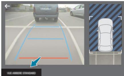
Para ativar a câmara situada na porta da mala, engrene a marcha-atrás e não exceda uma velocidade de 10 km/h.
