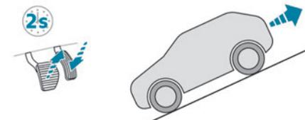
**Em descidas, com o veículo imobilizado e a marcha-atrás engrenada, este mantém-se imobilizado durante um curto período de tempo, ao soltar o pedal do travão.**
