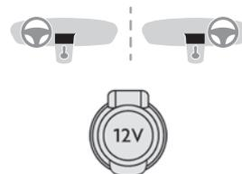
► Ligue um acessório de 12 V (com uma potência nominal máxima de 120 W) utilizando um adaptador adequado.
