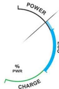
**POWER** Procura elevada de energia, utilizando as capacidades combinadas do motor a gasolina e de motor(es) elétrico(s) (dependendo da versão).
