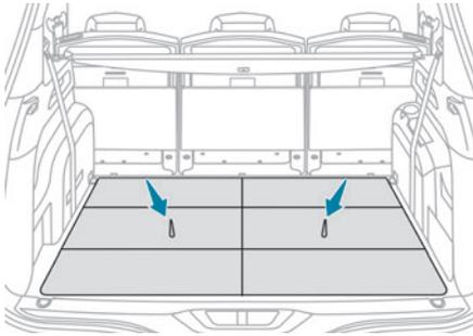
▶ Puxe uma das correias, as 3 partes do piso correspondente dobram-se em forma de concertina. Quando os bancos da 3ª fila estiverem endireitados, estes painéis laminados podem ser deixados na vertical ou planos por trás dos bancos (o que permite libertar o painel metálico como espaço para arrumação).
