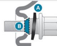
Se o veículo estiver equipado com jantes de alumínio, as anilhas **A** não devem entrar em contacto com a roda sobresselente de aço ou utilização temporária. A roda é mantida no respetivo local pela superfície de contacto cónica **B** de cada parafuso.
