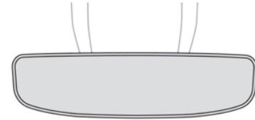
O sistema de electrocromados utiliza um sensor que deteta o nível de luminosidade exterior, que também é proveniente da parte traseira do veículo, para alternar, automática e gradualmente, entre a utilização diurna e noturna.
