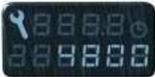
5 segundos depois da ligação da chave, o conta-quilómetros passa ao funcionamento normal e o visor indica a quilometragem total ou diária.
