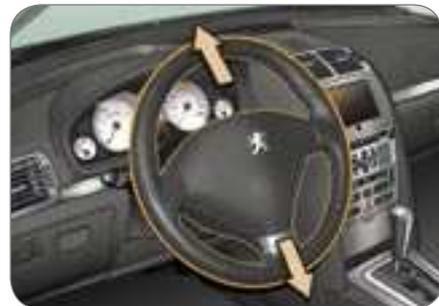
À abertura da porta do condutor e com a ignição desligada, o volante sobe para facilitar o acesso ou a saída do seu veículo.
