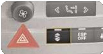
A suspensão adapta-se automática e instantaneamente aos diferentes tipos de condução e a todos os perfis da estrada para conciliar o melhor possível o conforto dos passageiros e a estabilidade do veículo. A suspensão privilegia um amortecimento suave assegurando o conforto. Assim que as condições o exigirem (condução desportiva, curvas apertadas, manobras de desvio...) ela selecciona automaticamente um amortecimento firme que garanta uma óptima estabilidade na estrada.
