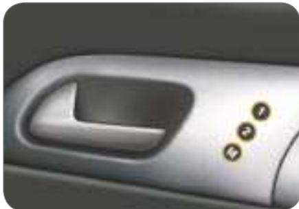
A memorização toma em conta o ajuste eléctrico do assento e dos retrovisores exteriores.
