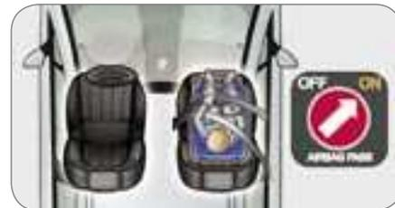
Quando um banco para crianças "de frente para a estrada" estiver instalado **no lugar do passageiro da frente**, regular o banco do veículo na posição longitudinal intermédia com o encosto levantado e deixar o airbag passageiro activado\*\*.
