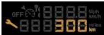
Depois da visualização da manutenção e do nível de óleo, o conta-quilómetros passa ao funcionamento normal e a chave permanece acesa.
