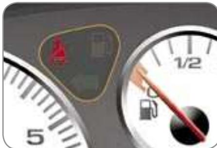
Após **ligar a ignição**, se um passageiro dianteiro não tiver apertado o cinto de segurança e se a velocidade do veículo for **inferior a 20 km/h**, será alertado pela **luz avisadora do cinto de segurança** que se acende.
