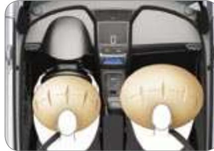
Estão integrados no centro do volante para o condutor e no painel de bordo para o passageiro da frente. Deflagram simultaneamente excepto se o airbag passageiro estiver neutralizado.
