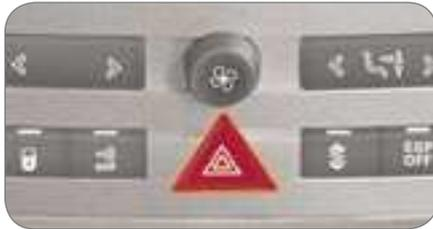
Premindo o botão, todas as luzes indicadoras de mudança de direcção piscam. Podem funcionar com a ignição desligada.
