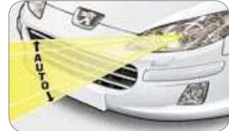
Nos veículos equipados com lâmpadas de xénon: com o veículo **imobilizado**, este sistema corrige automaticamente a altura do raio luminoso qualquer que seja a carga do veículo. O condutor tem assim a certeza de dispor de uma iluminação otimizada e de não ocasionar quaisquer dificuldades aos outros automobilistas.
