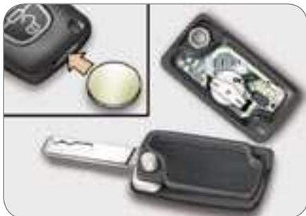
Para substituir a pilha, com uma moeda soltar a tampa ao nível do anel (pilha CR. 1620/03 volts).
