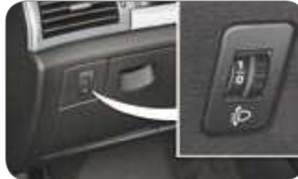
Para os veículos equipados de lâmpadas halogénias, em função da carga do veículo, recomenda-se a correcção do feixe dos faróis:
