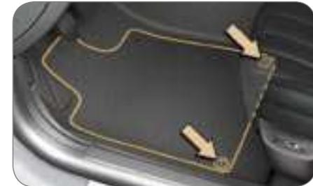
Para desmontar o tapete do lado do condutor, recuar o banco ao máximo e retirar as fixações.
