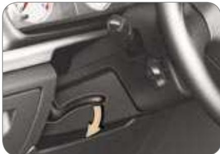
Com o veículo parado, para desbloquear o volante empurre o comando para a frente.
