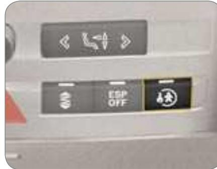
Impede a abertura, a partir do interior, das duas portas traseiras.
