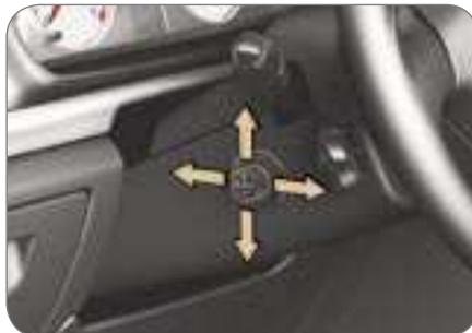
Com o veículo parado, ajustar a altura ou a profundidade do volante movendo o comando:
