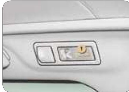
Com a chave na ignição, accionar o interruptor correspondente.
