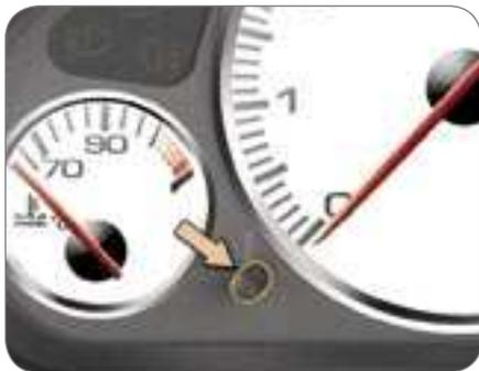
Com os faróis acesos, carregar no botão para variar a intensidade da iluminação do posto de condução. Quando a iluminação atingir o ajuste mínimo (ou máximo), soltar o botão e em seguida tornar a carregar para aumentá-la (ou diminuí-la).
