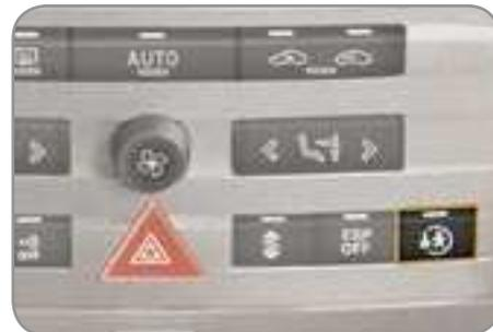
Impede a abertura, a partir do interior, das duas portas traseiras.
