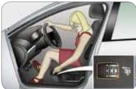
Com o motor a funcionar, girar o botão rotativo. A temperatura do banco é regulada automaticamente.
