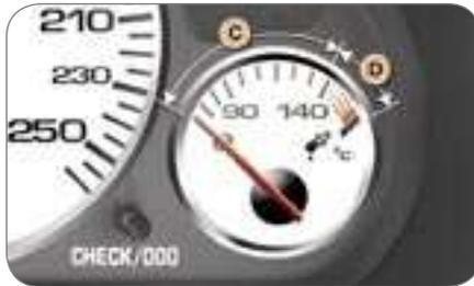
Ao ligar a ignição ou com o veículo em movimento, indica a temperatura do óleo motor.
