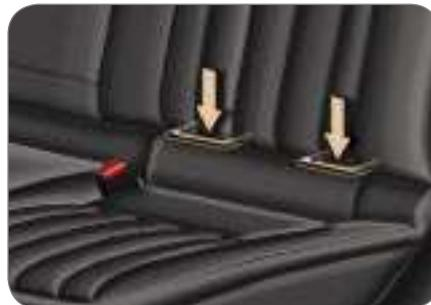
Este sistema de fixação ISOFIX assegura-lhe uma montagem fiável, sólida e rápida do banco para crianças no seu veículo.
