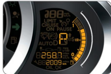
Quando deslocar a alavanca na grelha para seleccionar uma posição, acende-se o respectivo indicador no quadro de bordo.
