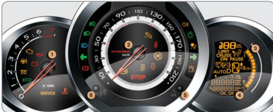
Painel que agrupa visores e luzes avisadoras de funcionamento do veículo. Consoante as versões, este quadro de bordo pode possuir uma retroiluminação permanente.
