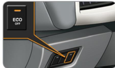
A qualquer momento, pressione o comando "ECO OFF" para neutralizar o sistema.
