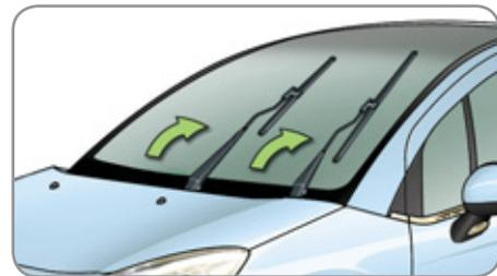
Esta posição permite que as escovas fiquem elevadas para o estacionamento de Inverno, sejam limpas ou substituídas sem danificar o capot.
