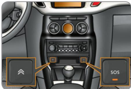
Este dispositivo permite efectuar uma chamada de emergência ou de assistência para os serviços de socorro ou para a plataforma CITROËN dedicada. Para obter mais detalhes sobre a utilização deste equipamento, consultar o capítulo "Áudio e telemática".
