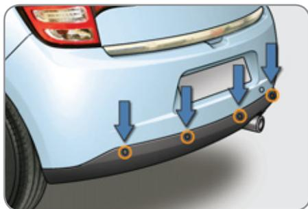
Detecta qualquer obstáculo (pessoa, veículo, árvore, barreira, ...) situado por trás do veículo, excepto os obstáculos situados exactamente sob o pára-choques.
