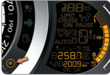
As quilometragens totais e diárias são visualizadas durante trinta segundos ao desligar a ignição, ao abrir a porta do condutor, bem como no trancamento e destrancamento do veículo.
