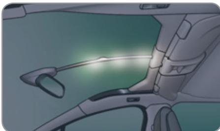
Em determinadas versões, três lâmpadas, situada no tubo que liga o tejadilho e o retrovisor dia/noite automático, acendem-se igualmente.
