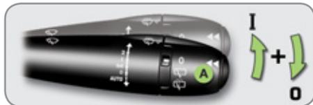
É comandada manualmente pelo condutor empurrando o comando **A** para cima e colocando-a na posição "0".
