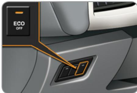
Em caso de problema de funcionamento do sistema, o avisador do comando "ECO OFF" funciona de forma intermitente e, em seguida, acende-se fixamente.
