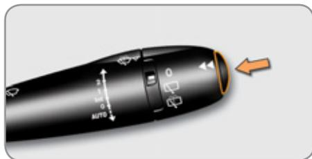
☞ Prima o botão, situado na extremidade do **comando do limpa-vidros**, para visualizar sucessivamente os diferentes separadores do computador de bordo:
