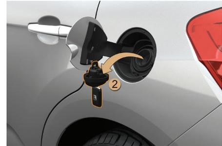
**i** Enquanto a tampa não for colocada no tanque, a chave não pode ser retirada da fechadura. Ao abrir a tampa, pode ouvir-se um ruído de aspiração de ar. Esta depressão, que é normal, é provocada pela estanqueidade do circuito de combustível.
