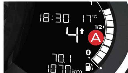
**i** O sistema adapta as instruções de alteração de marcha em função das condições do deslocamento (inclinação da via, carga,...) e das solicitações do condutor (solicitação de potência, aceleração, frenagem,...).
