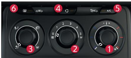
Os sistemas de aquecimento ou de ar condicionado só funcionam com o motor ligado.
