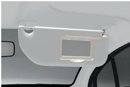
Os para-sóis, encontram-se equipados com um espelho de cortesia, com tampa de ocultação.
