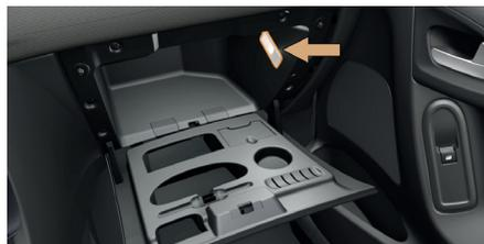
Desencaixe a tampa com uma chave de parafusos fina, para acessar a lâmpada com defeito.
