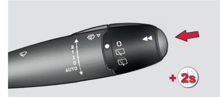
☞ Com a ignição ligada, pressione o botão existente na extremidade do comando do limpa-vidros, durante mais de dois segundos, até a aparição dos zeros.
