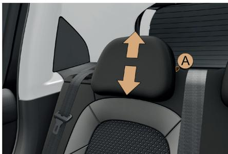
O banco traseiro 1/3 - 2/3 encontra-se equipado com encostos de cabeça. Estes encostos de cabeça possuem uma posição superior (conforto e segurança) e uma posição inferior (visibilidade traseira). Podem, também, ser desmontados; para retirar:
