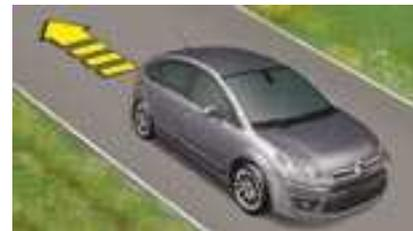
Numa descida, com o veículo parado e a marcha-atrás engrenada, este permanece imobilizado durante breves instantes após soltar o pedal de travão.
