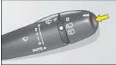
Para poder visualizar e seleccionar as diferentes informações, prima com breves impulsos a extremidade do comando do limpa-vidros da frente.
