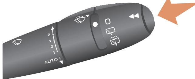
Cada pressão no botão, situado na extremidade do **comando do limpa-vidros**, permite mostrar sucessivamente os diferentes dados do computador de bordo, em função do ecrã.
