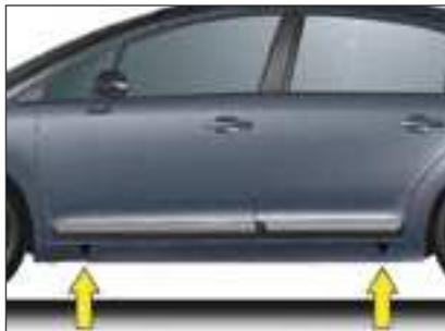
**4 -** Posicionar o macaco por baixo da carroçaria, de acordo com a ilustração, ao nível da marca **A** (na reentrância da embaladeira) mais perto do pneu a substituir.
