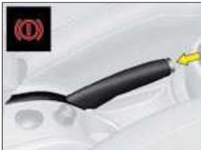
O travão de estacionamento deve ser accionado com o veículo parado, puxando pela alavanca, tanto mais energicamente quão acentuado for o declive.
