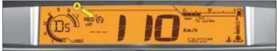
Uma vez atingida a velocidade pretendida, carregando no acelerador, prima a tecla **2** ou a tecla **4**. A velocidade de cruzeiro é então memorizada. Ela é apresentada na zona **A** do quadro de bordo.
