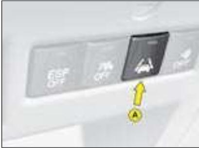
Este dispositivo de ajuda à condução alerta o condutor para uma ultrapassagem involuntária da marcação longitudinal no solo (traço contínuo ou descontínuo).
