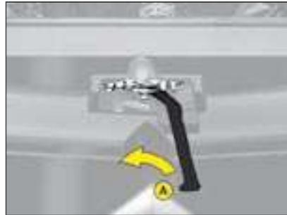
Accione a patilha **A** situada por cima da grelha, à direita dos chevrons e, em seguida, levante o capot.
