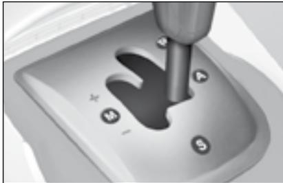
Um **modo automatizado** com a alavanca de velocidades na posição **A**.
