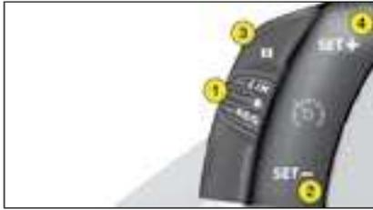
Este dispositivo de assistência à condução permite circular a uma velocidade à sua escolha, sem acção no acelerador. Este dispositivo fica activo acima dos 40 km/h aproximadamente, com a 4ª velocidade engrenada numa caixa de velocidades manual e a 2ª velocidade engrenada numa caixa automática.
