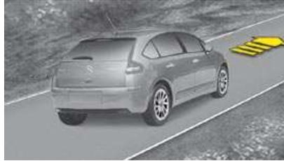
**Em subidas, com o veículo imobilizado, este é mantido durante um curto instante, aquando da libertação do pedal de travão:**
