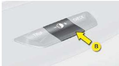
Sistema para adaptar manualmente a intensidade luminosa do posto de condução em função da luminosidade exterior.
