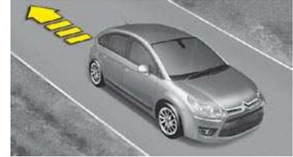
**Em descidas, com o veículo imobilizado e marcha-atrás engrenada, este é mantido durante um curto instante, aquando da libertação do pedal de travão.**
