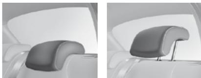
Os encostos de cabeça traseiros podem ser desmontados e possuem duas posições:
