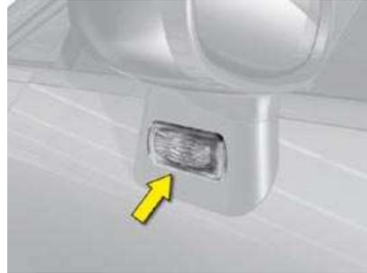
Para substituir a lâmpada, pressione com firmeza a zona indicada pela seta e puxe o bloco.
