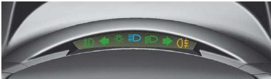
Referências visuais que informam o condutor relativamente ao funcionamento de um sistema (luzes avisadoras de marcha ou de neutralização) ou ao aparecimento de uma falha (luz avisadora de alerta).
