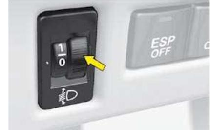
Para não incomodar os outros condutores, as luzes com lâmpadas de halogéneo devem ser reguladas em altura, em função da carga do veículo.
