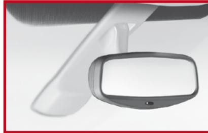
Para evitar o encandeamento, o espelho retrovisor interior escurece automaticamente em função da intensidade luminosa proveniente da traseira.
