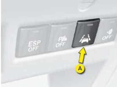
Sistema que detecta a transposição involuntária de uma linha longitudinal na superfície das vias de circulação (linha contínua ou descontínua).
