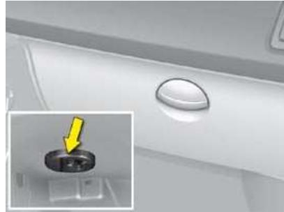
Possui refrigeração consoante o seu equipamento, através de uma saída de ventilação obturável manualmente.
