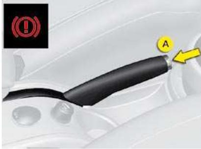
Dispositivo mecânico para manter o veículo imobilizado.
