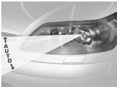
Para não prejudicar os outros utilizadores da estrada, este sistema corrige, automaticamente ou com o veículo parado, a altura das luzes de xénon, em função da carga do veículo.
