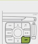
! Para ejectar a pen USB, utilizar o menu de atalho (premir ok) ou premir a tecla MENU, seleccionar FUNÇÕES ÁUDIO, USB, de seguida seleccionar EJECTAR USB.
