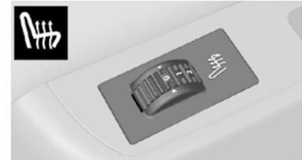
Com o motor em funcionamento, os bancos dianteiros podem ser aquecidos separadamente.
