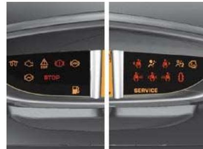
Com o motor em funcionamento ou o veículo em movimento, a iluminação de uma das luzes avisadoras que se seguem indica o aparecimento de uma falha que exige a intervenção do condutor.
