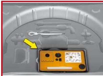
O kit encontra-se arrumado na mala, por baixo da superfície inferior. Encontra-se instalado na caixa de ferramentas, situada sob a caixa de arrumação.
