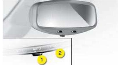
Para evitar o encandeamento, o espelho retrovisor interior escurece automaticamente em função da intensidade luminosa proveniente da traseira.
