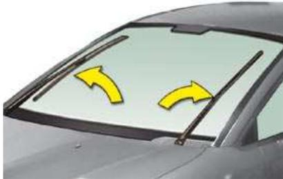
No minuto que se segue ao corte da ignição, qualquer acção no comando do limpa-vidros posiciona as escovas a meio do pára-brisas.
