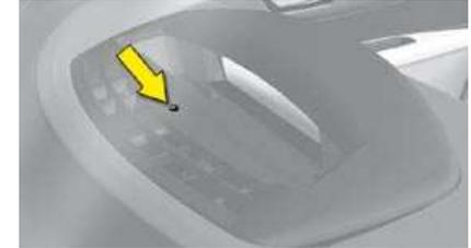
A regulação automática do ar condicionado no interior do habitáculo utiliza o sensor de raios solares, situado no painel de bordo por trás do quadro de bordo.
