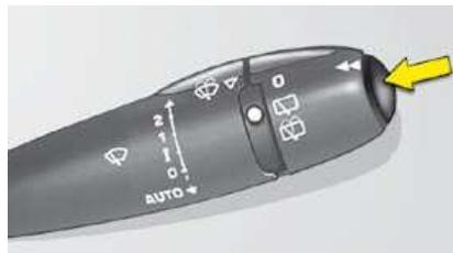
Prima o botão, situado na extremidade do comando do limpa-vidros, para visualizar sucessivamente os diferentes separadores do computador de bordo:
