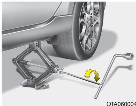
8. Introduza o rabo do macaco no macaco e rode-o no sentido dos ponteiros do relógio, levantando o veículo até o pneu ficar mesmo acima do chão, a uma altura de aproximadamente 30 mm. Antes de retirar as porcas da roda, certifique-se de que o veículo está estável e que não há possibilidade de se mover ou deslizar.
