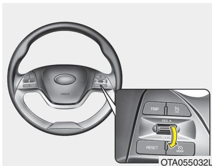
3. Desça o manípulo (para SET-) e liberte-o na velocidade pretendida. O indicador luminoso SET acende-se no painel de instrumentos. Liberte o pedal do acelerador ao mesmo tempo. A velocidade pretendida será automaticamente mantida.
