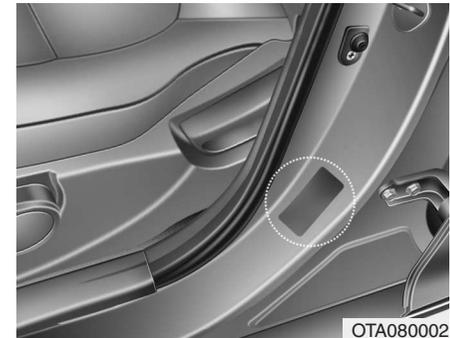
O número de identificação do veículo (VIN) é indicado na etiqueta de certificação do veículo, colocada no pilar central do lado do condutor (ou do passageiro da frente).
