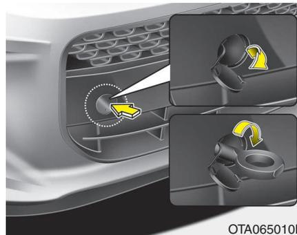
**Gancho de reboque removível (frente, se instalado)**
