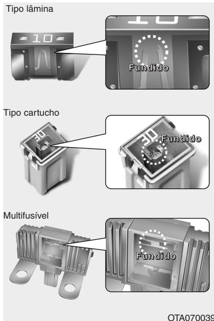
Os fusíveis protegem o sistema eléctrico de um veículo contra danos causados por uma sobrecarga eléctrica.
