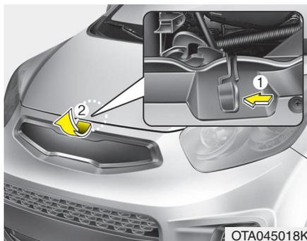
2. Vá à dianteira do veículo, levante um pouco o capô, puxe o fecho secundário (1) central e levante o capô (2).
