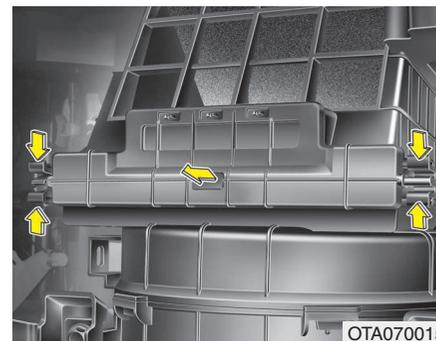
2. Retire a tampa do filtro de ar do sistema de controlo da climatização, carregando no respectivo fecho situado de ambos os lados da tampa.
