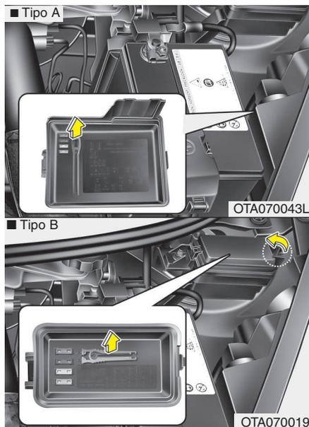
3. Com a ferramenta de remoção existente no painel de fusíveis do compartimento do motor, puxe o fusível suspeito a direito para fora.
