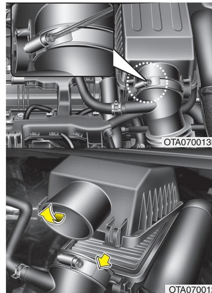
2. Com uma chave de parafusos desaperte a braçadeira do tubo do filtro de ar.
