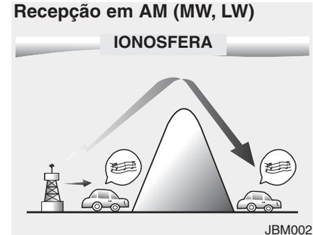
A recepção dos sinais de AM (MW, LW) é, normalmente, melhor do que em FM. Isto deve-se ao facto das ondas de AM (MW, LW) serem transmitidas em baixas frequências. Estas ondas longas, de baixa frequência podem seguir a curvatura da Terra, em vez de seguirem a direito para a atmosfera. Além disso, dão a volta aos obstáculos, assegurando assim uma cobertura mais perfeita.
