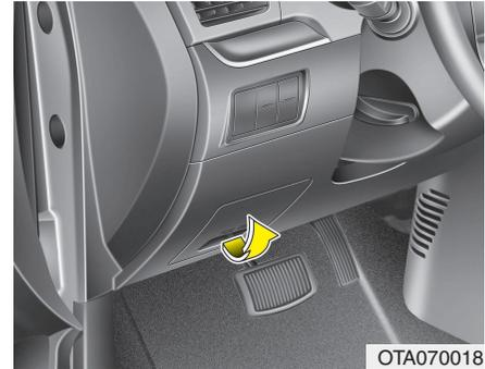
**Substituição no painel de fusíveis interior**
