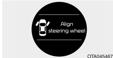
Se ligar o motor com a direcção virada 90° para a esquerda durante alguns segundos, a mensagem "Align steering wheel (Alinhamento de direcção)" surge no visor LCD durante 5 segundos.
