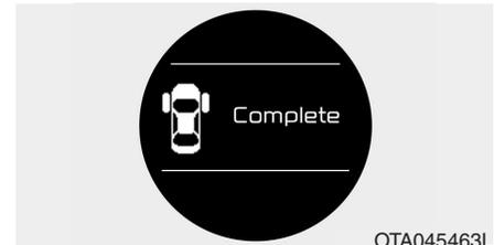
Se a direcção for alinhada nos 5 segundos a seguir à mensagem no ecran "Align steering wheel (Alinhamento de direcção)" O indicador irá surgir durante 1.5 segundos conforme imagem em cima.
